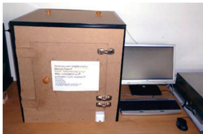
Abb. 2: Messsystem in Rosenheim mit Dunkelkammer und Kontrollmonitor
