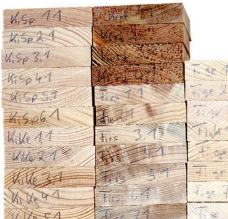
Abb. 1: Vorbereitete Holzproben nach dem Zuschnitt
