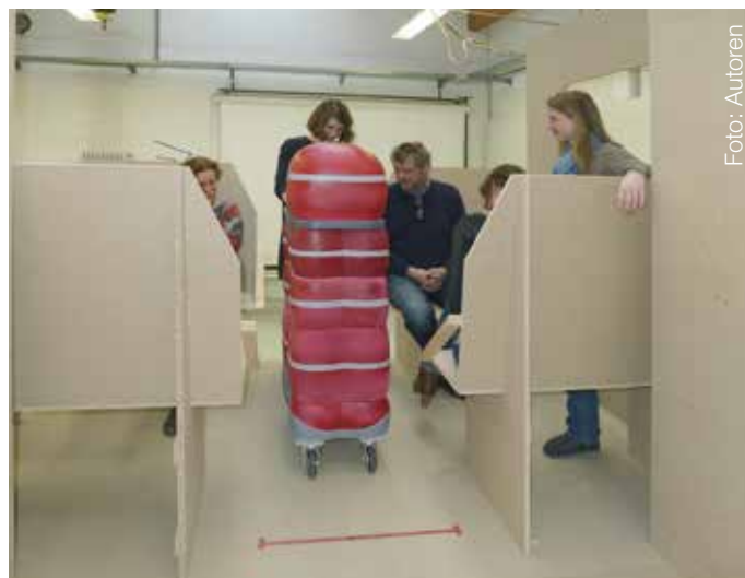
Handlingtest eines Catering-Trolley im Innenraum-Versuchsaufbau
