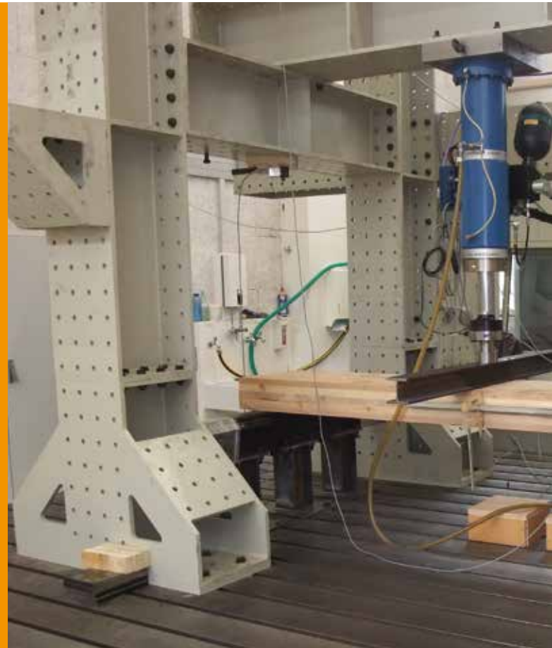
Biegeprüfung eines fünfschichtigen Hybrid-Brettsper Holzträgers in der Bauteilhalle der Hochschule Rosenheim
