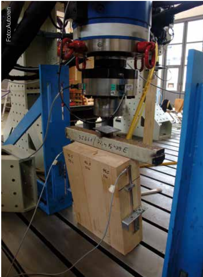
Scherprüfungen an BSP-Elementen zur Ermittlung des Rollschubmoduls
