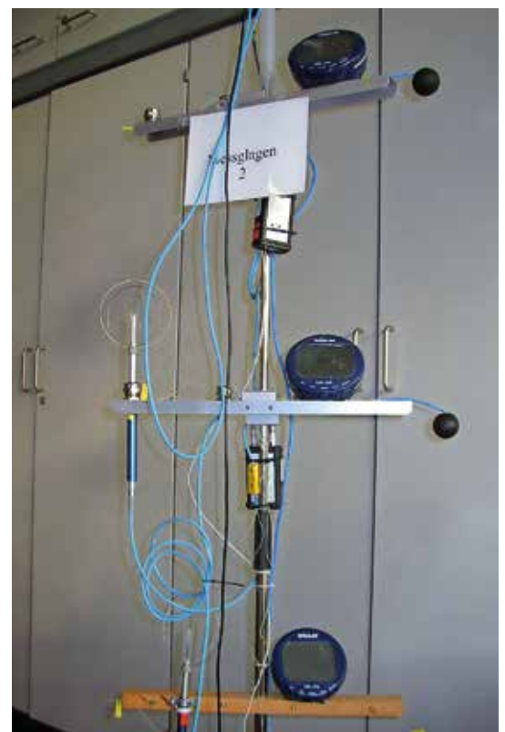
Abb. 3: Messausrüstung zur Ermittlung raumluftechnischer Parameter
