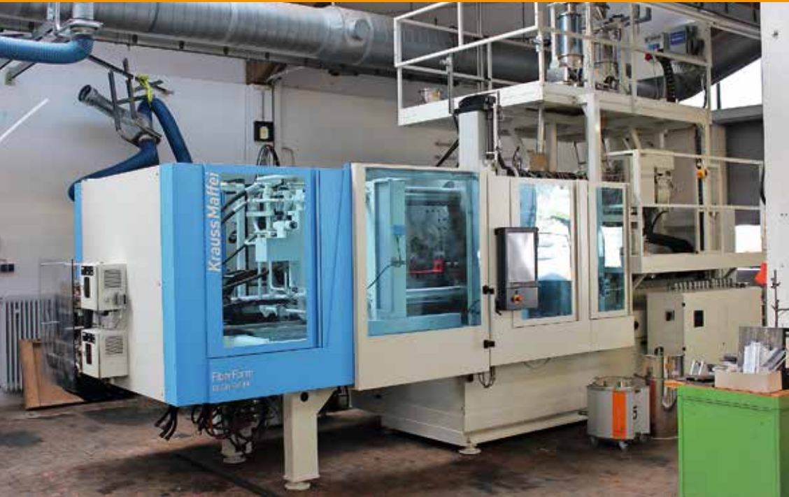
Abb. 3: Erste Ausbaustufe der Spritzgiess- anlage mit der Compoundiereinheit (rechts).
