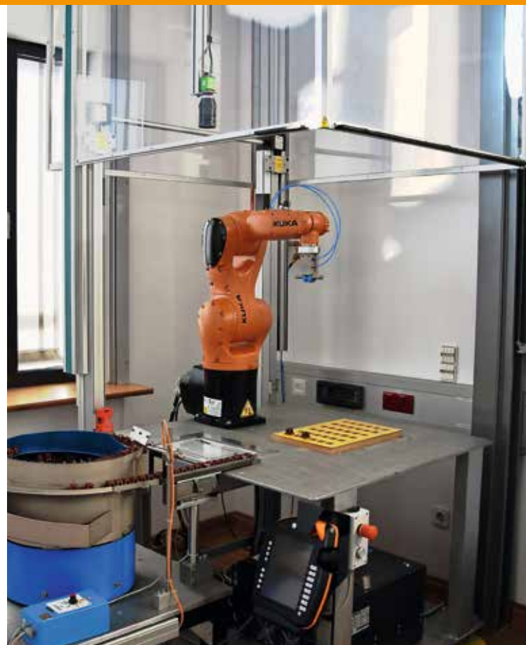
Kraftsensitive Montage mit dem LBR iiwa und kameragestützte Robotertechnik für Handlingsaufgaben
