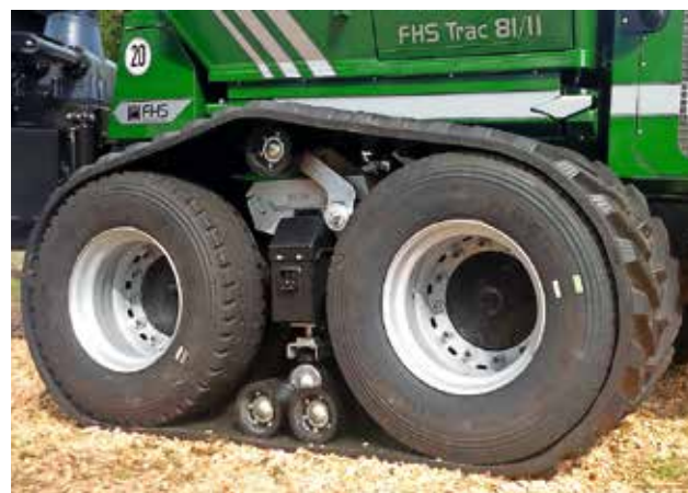
Abb. 1: Neu entwickeltes Bänderlaufwerk der Fa. FHS Forsttechnik Handel und Service GmbH; Bogie-Achse mit steuerbarer Stützrolle und umlaufendem Band
