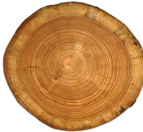
Imprägnierte und oberflächenbehandelte Hirnholzscheibe aus Lärche
