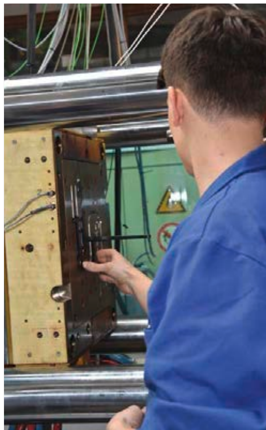
Abb. 4: Um die im Verlauf des Spritzgussprozesses entstehenden Werkstoffeigenschaften zu untersuchen, stellt das Projektteam regelmäßig Prüfkörper her.
