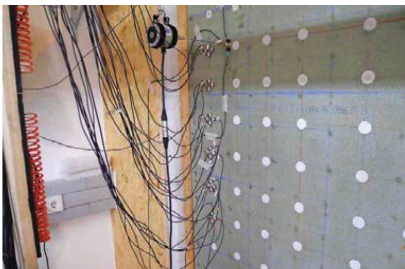
Abb. 3: Schwingungsaufnehmer zur Modal- und Körperschallintensitätsanalyse
