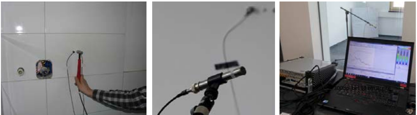
Abb. 2 bis 4: Das Projektteam führt umfangreiche Messungen an bestehenden Holzbauten durch, um belastbare Referenzwerte für verschiedene Übertragungssituationen zu erhalten.
