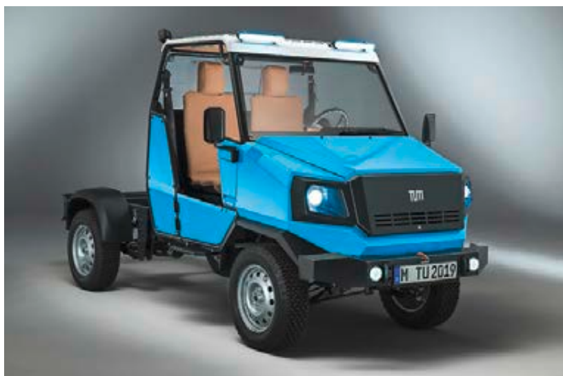
Abb. 7: So sieht das Grundmodul des neuen Fahrzeugs aus. Auf die Hinterachse können verschiedene Aufbauten montiert werden. Das Fahrzeug wird elektrisch betrieben. Bild: TU München
