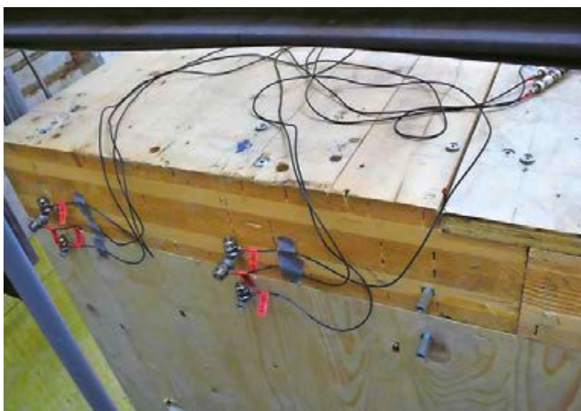
Abb. 4: Messung der Schallübertragung an Stoßstellen im Brettsperrholzbau
