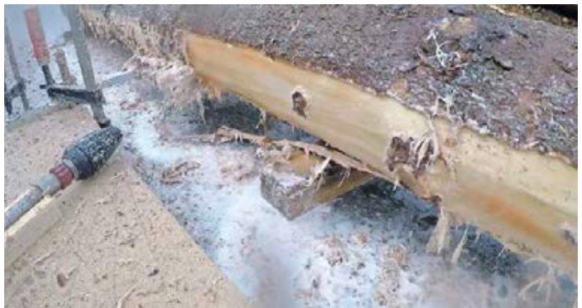
Entrindung per Wasserstrahl
