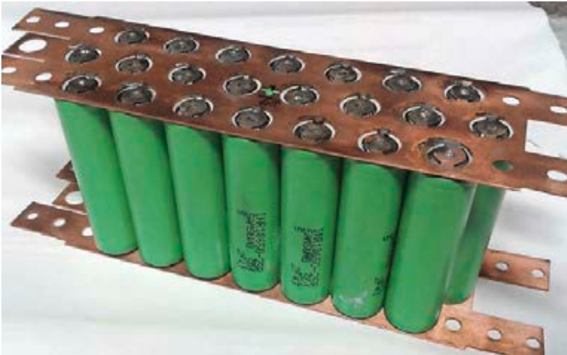
Abb. 4a: Batteriemodul bestehen aus 22 parallel geschalteten 18650 Li-Zellen
