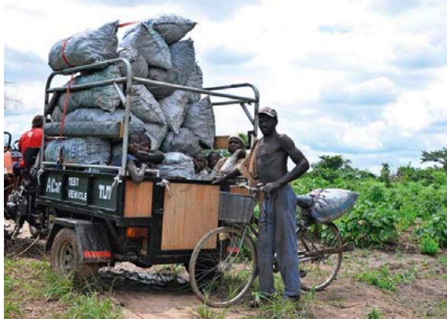
Abb. 2: Entwickelt wird ein Fahrzeugkonzept mit einfachen Technologien, das sich modular aufbauen und montieren lässt und den Transport von Personen und Gütern erlaubt. Zum Einsatz kommen regionale Materialien und verfügbare Handwerkstechniken. Bild: Mandolin Maidt
