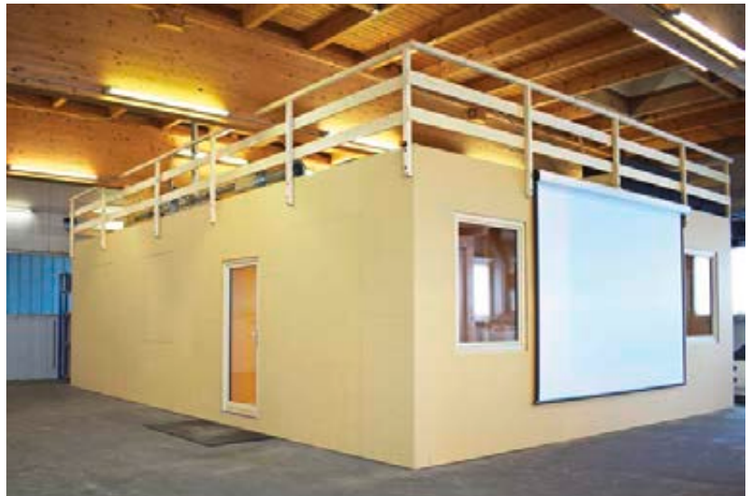
Abb. 2: In der 70 m 2 großen Forschungswohnung können energetische und lüftungstechnische Maßnahmen im Realmaßstab untersucht und bewertet werden.
