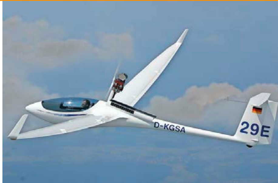
Abb. 2: Leistungssegelflugzeug mit konventionellem 2-Takt-Motor als Hilfsantrieb
