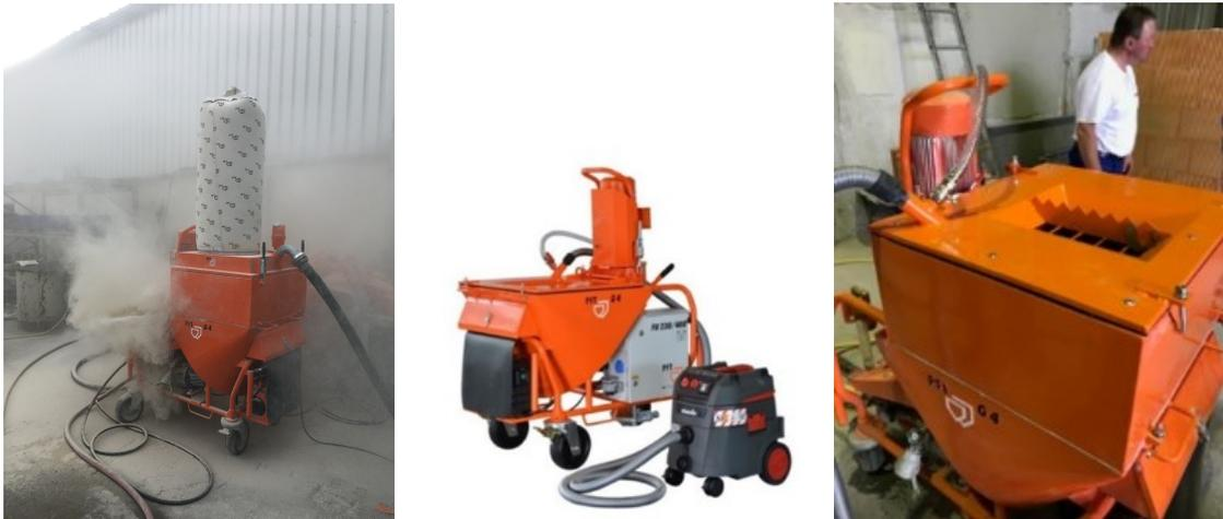
Abbildung 10.37: Links: Fehlgeschlagener Trockenförderungsversuch mit massiver Staubentwicklung. Rechts: Putzmaschine mit speziellem neuem Einfüllkasten (PFT Anti-Dust Anlage) und Staubabsaugung
