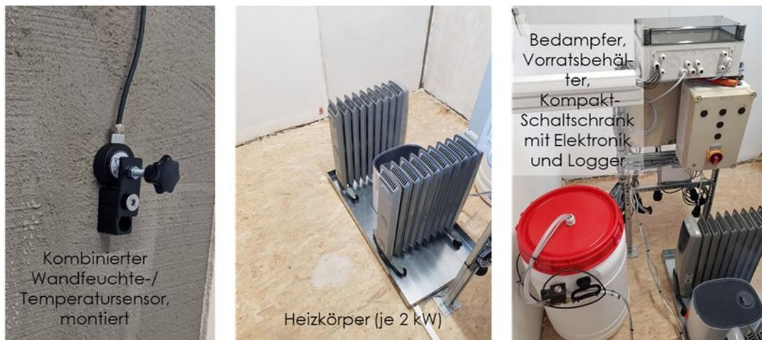
Abbildung 10.10: Installation der Sensorik und Steuerung/Elektronik mit Beheizung und Befeuchtung
