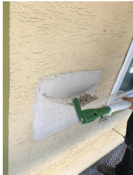
Abbildung 10.35: Gewebeabreißtest mit dem Haftvermittler zur Prüfung der Haftfestigkeit auf Altputz
