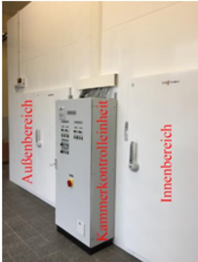
Abbildung 7.19: Vorderansicht der Differenzklimakammer. Abbildung entnommen aus [83].
