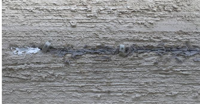
Abbildung 9.3: Temperaturfühler (mit Wärmeleitpaste versiegelt) an der Wandaußenseite
