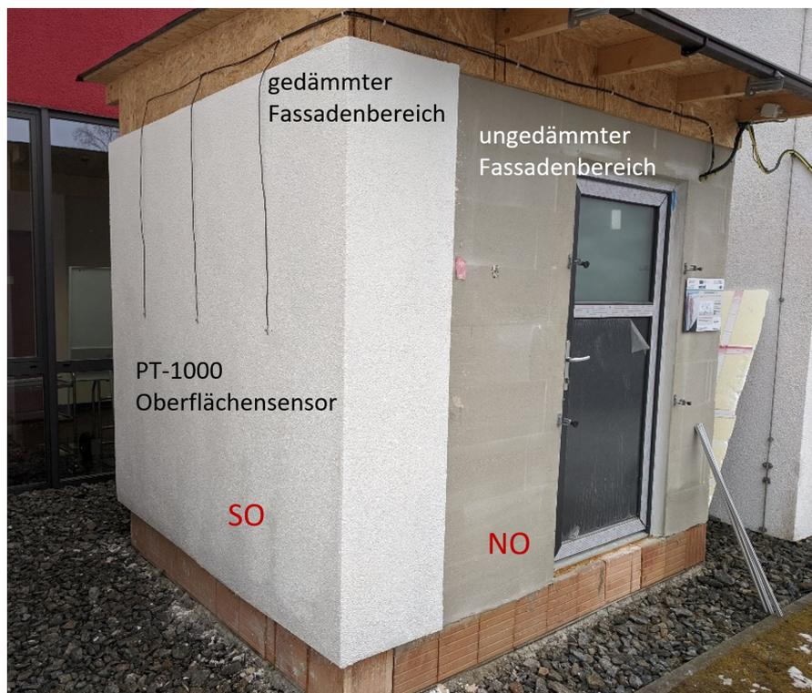
Abbildung 10.21: Außenansicht der Ecohütte mit ungedämmter und gedämmter Fassade
