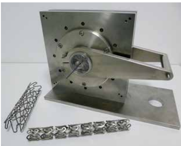
Neuartige Vorrichtung zum Befestigen von koronaren Stents auf Ballonkathetern (im Vordergrund: 100x größere Modelle von koronaren Stents)
