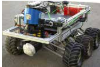
Abbildung 1: Geländegängige High-Speed-Roboterplattform Innok TX
