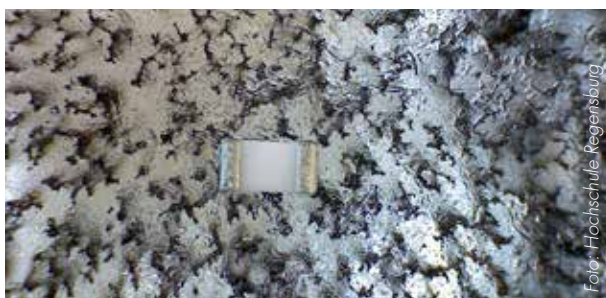
Abbildung 1: Aufsicht auf eine in einem Magnetfeld von 450 mT ausgehärtete Probe mit einem Eisenanteil von 5 wt.-%
