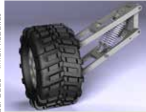
Abbildung 2: CAD-Entwurf der gefederten Aufhängung des Innok TX
