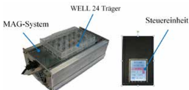
Abbildung 3: Beispiel eines aufgebauten Magnetisierungssystems zur aktorischen Steuerung der Zellsubstrate
