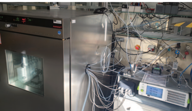
Abbildung 3: Laborprüfstand mit Klimakammer (links) und Messtechnik (rechts).
