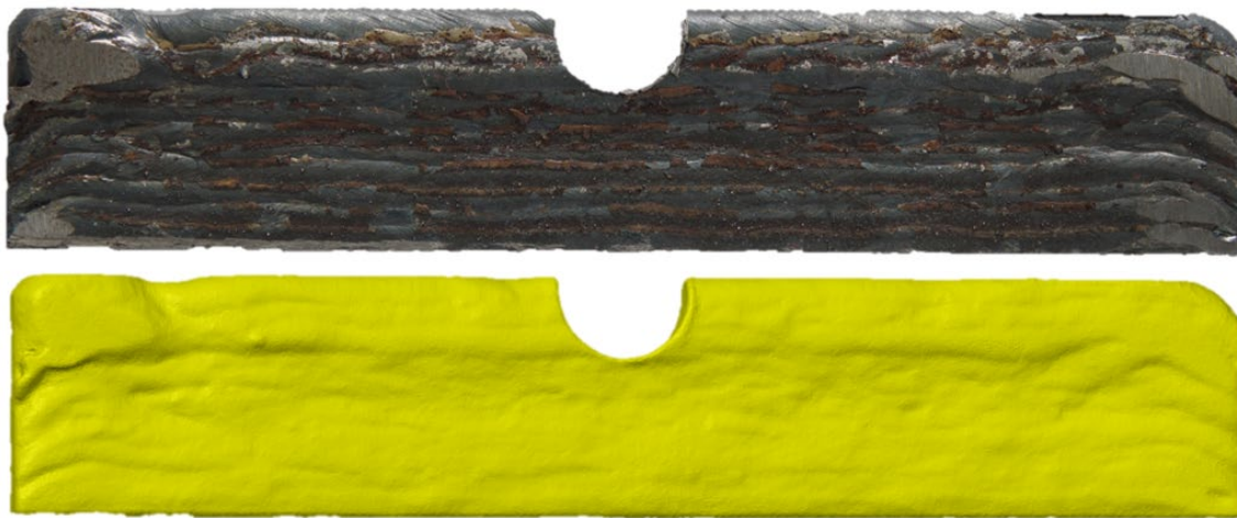
Bild 5: Angefertigte Probe für die statistischen Versuchsauswertung (oben) 3D-gescannte Probe (unten)
