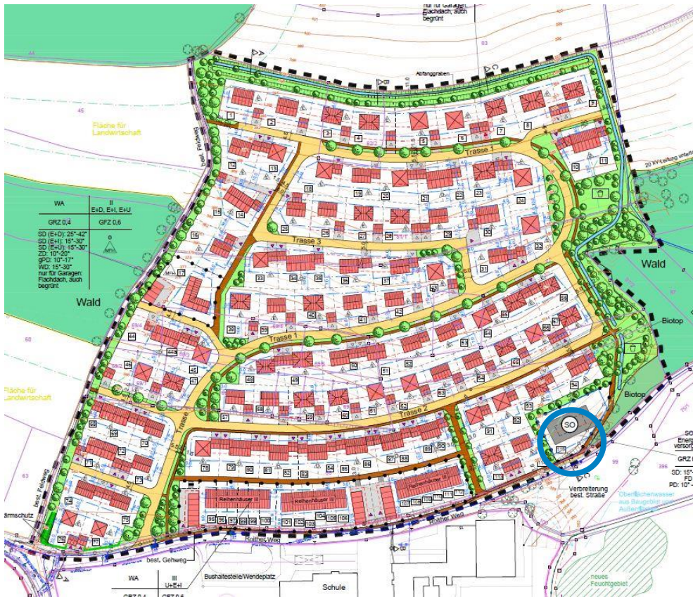
Abbildung 5: Übersicht des Nahwärmenetzes in Wenzelbach
