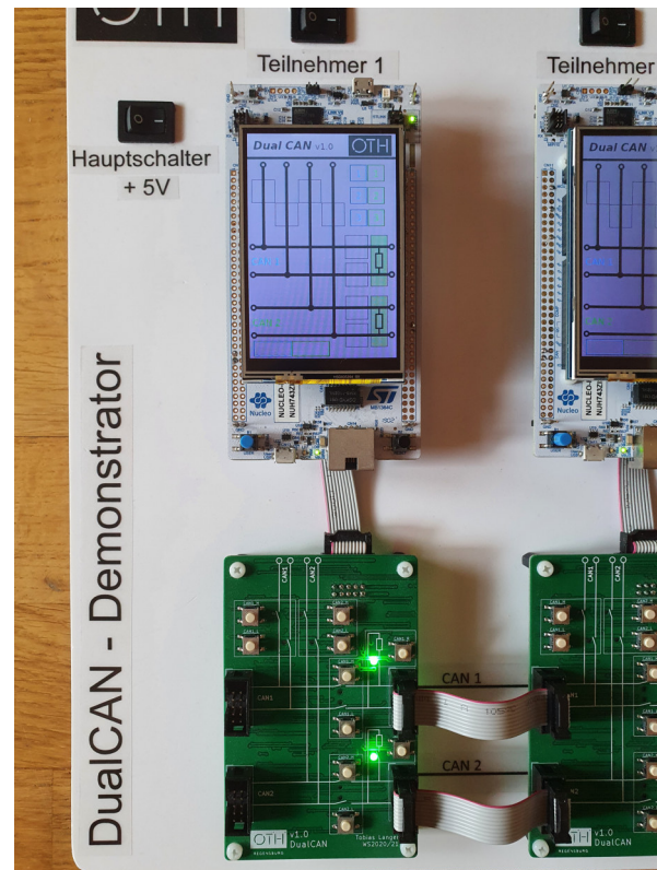
Abbildung 3.2.11: Failure Injection Board: Abschlusswiderstände
