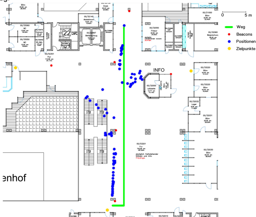
Abbildung 8: Durchgeführter Testlauf. Auffinden der Blutabnahme mit einer Gesamtwegstrecke von etwa 45m. Die blauen Punkte markieren die gemessenen Positionen während des Laufs, die grüne Markierung den idealisierten/zu laufenden Weg. Die Positionen der platzierten iBeacons sind rot markiert.
