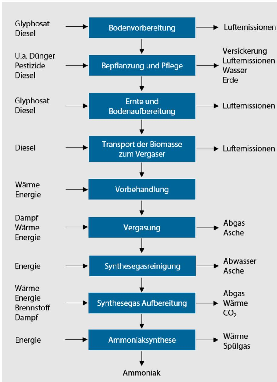
**Abbildung 10:** Blockdiagramm der Ammoniakerstellung via Biomassevergasung nach [44].
