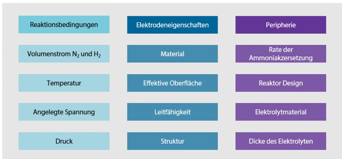
**Abbildung 16:** Einflussfaktoren auf die elektrochemische Ammoniakherstellung mit Feststoffelektrolyt nach [66].
