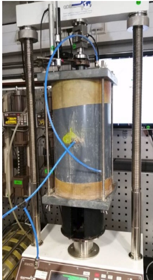
Abbildung 50: RESIST-Probe bei Prüfung in der Universalpresse.
