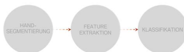
Abbildung 1: Die wesentlichen Schritte in der bildbasierenden Gestenerkennung.
