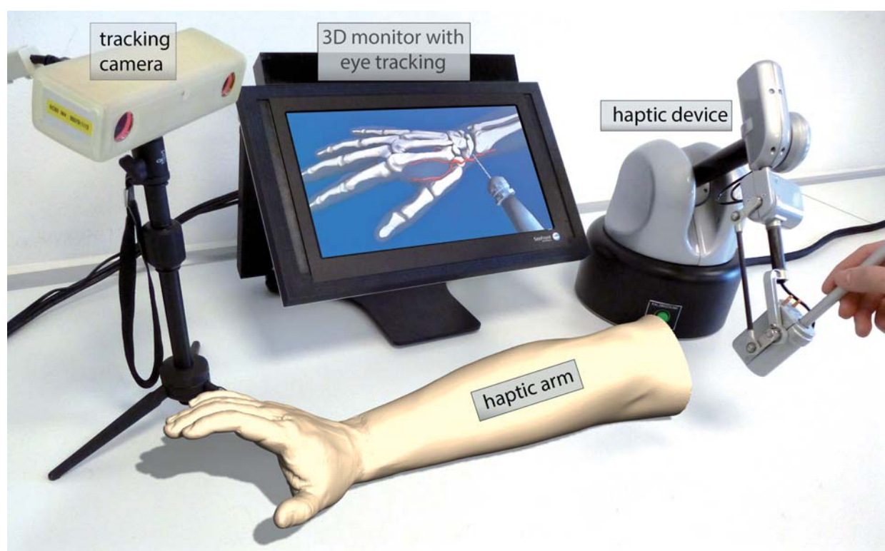
Grafik 1: Exemplarischer Aufbau des Trainingssystems. Rechts: Der haptische Arm für haptische Kräfte rückmeldung und Bahnverfolgung des Bohrers. Links: Die stereoskopische Kamera für das Tracking des Haptik-Phantoms. Im Vordergrund das haptische Phantom für die bimanuale Haptik und im Hintergrund der autostereoskopische 3D-Monitor.
