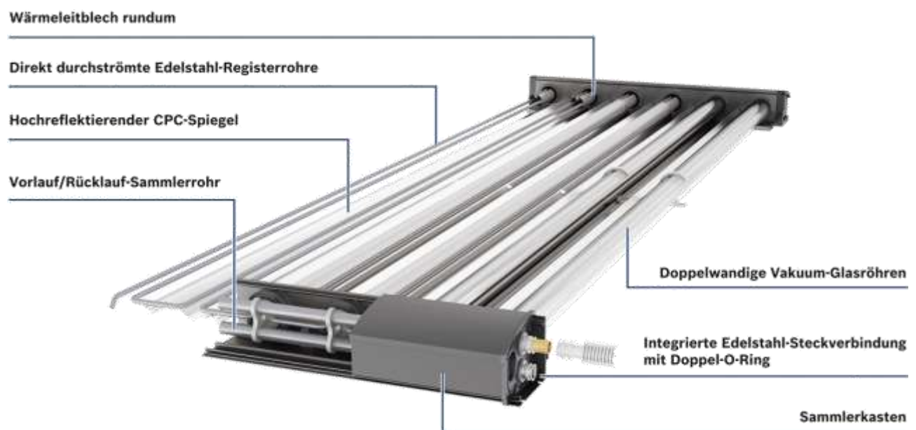
Abbildung 2.3 Vakuumröhrenkollektor mit CPC – Spiegel [7]
