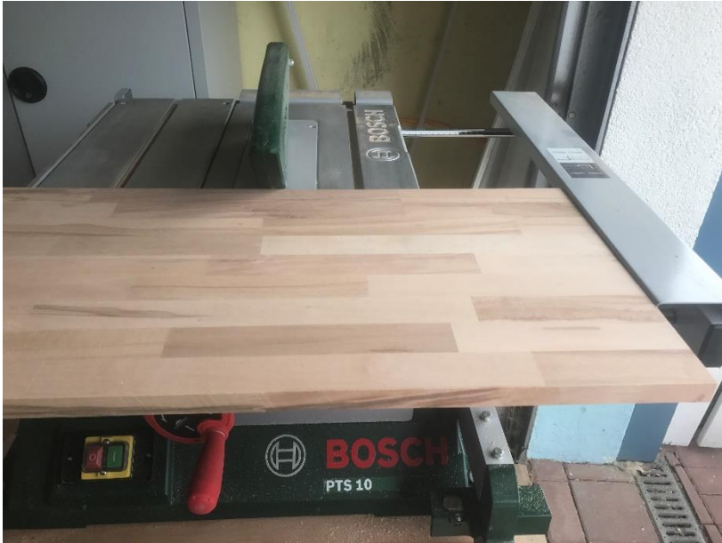
Zuschnitt auf Maß und Fasern anschleifen
