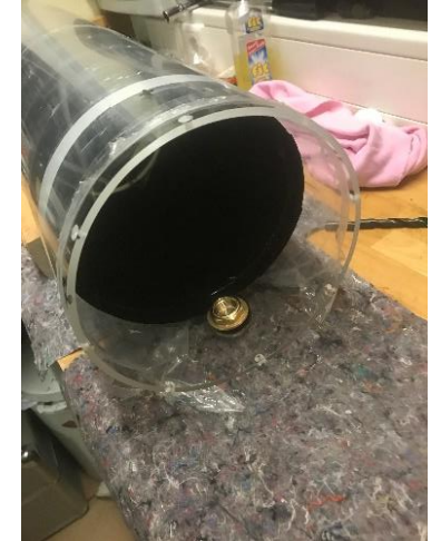
Verklebung der Membran am inneren und äußeren Kolben
