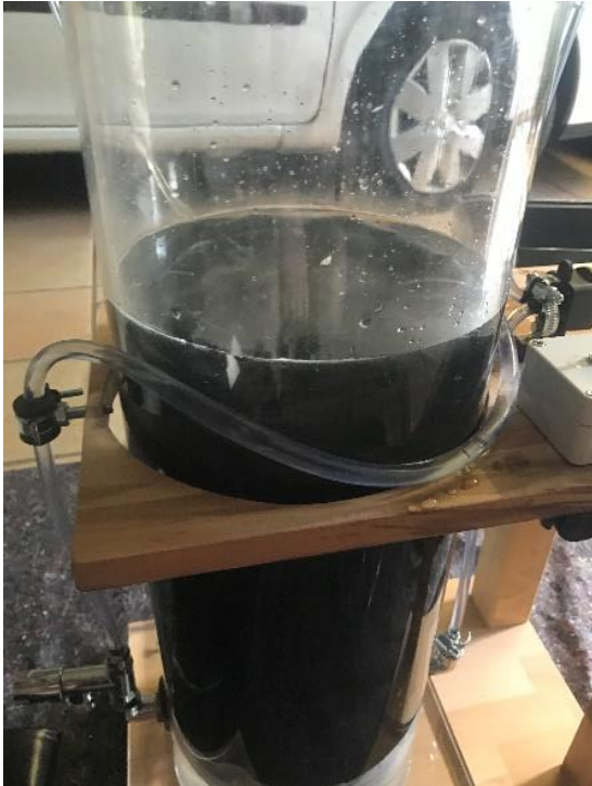
Befüllung mit Wasser Dichtigkeitsprüfung
