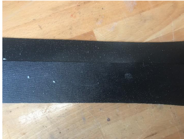
Klebeversuch nur mit einer Quellschweißklebung
