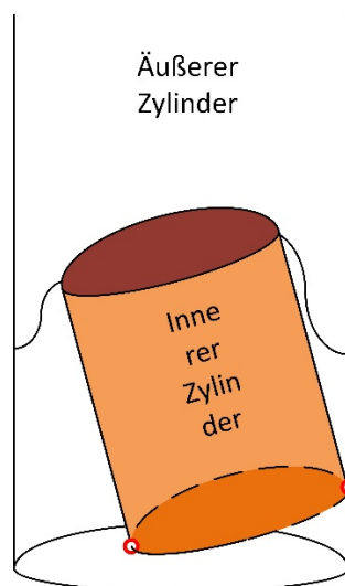
Abbildung 6: Innerer Zylinder gerät in Schiefelage.
