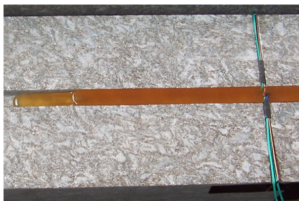
Bild 6.7: vollgefüllter Injektionskanal mit zungenförmiger Ausbildung der Injektionsfront
