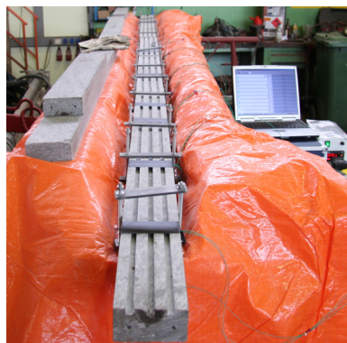
Bild 6.9: Fotografie des geöffneten Injektionskanalsystems
