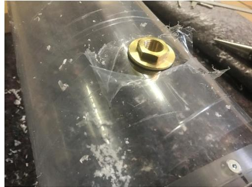
Abbildung 23: Einschraubung für die Zuleitung
