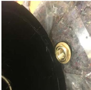
Abbildung 45: Befestigung der Membran am großen Kolben
