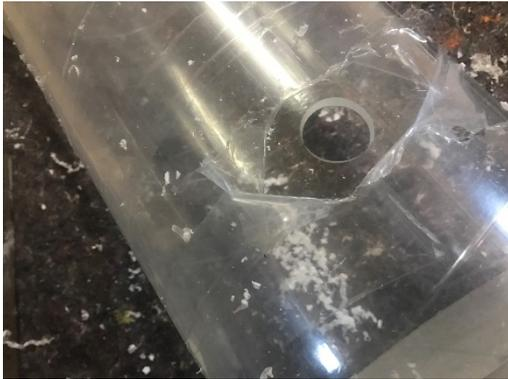
Abbildung 22: Bohrung für die Zuleitung der Pumpe
