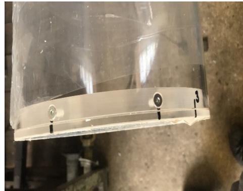
Abbildung 20: Deckel verschraubt
