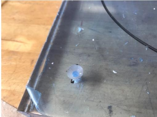
Abbildung 12: Grundplattenbohrung mit Senkung 1
