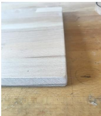
Abbildung 9: Fasen anschleifen
