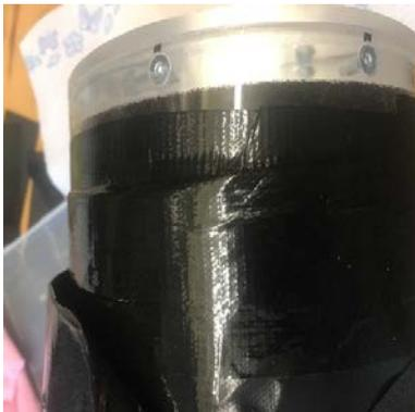
Abbildung 44: Befestigung der Membran am Kolben
