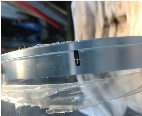
Abbildung 17: Bohrung anzeichnen
