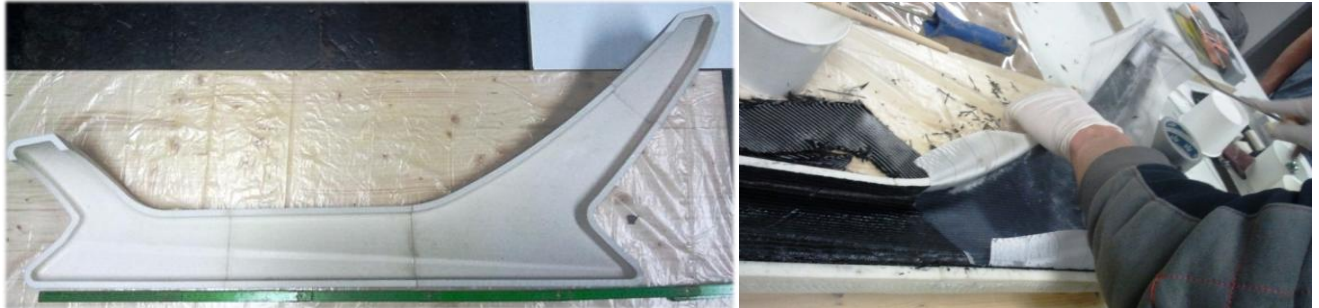
Abbildung 16: Im FDM-Verfahren hergestellte Laminierform und Laminieren der Chassishälfte [BÖHM 2012]
