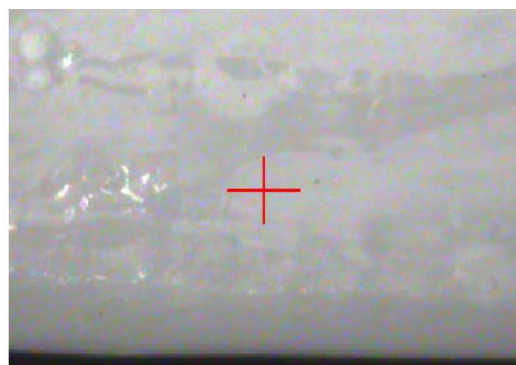
Abbildung 13: Mit Dimethylketon behandelter ABS-Prüfkörper
