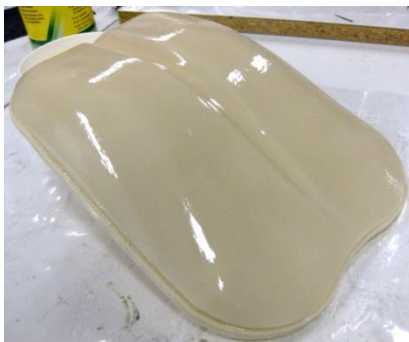
Abbildung 18: Fertig bearbeitete Negativformen für das innere Schaufelblatt (links) und der Halterung (rechts)
