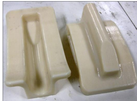
Abbildung 18: Fertig bearbeitete Negativformen für das innere Schaufelblatt (links) und der Halterung (rechts)
