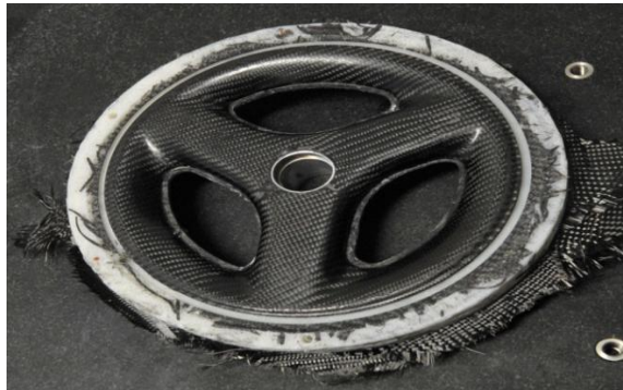
Laminierte CFK-Felge mit noch nicht gelöstem Kernmaterial
