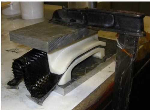
Abbildung 19: Laminieren der Schaufelstielhalterung und laminiertes CFK-Schaufelblatt
