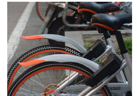
Sicher ist sicher: Durchlöcherter Gummiräder
