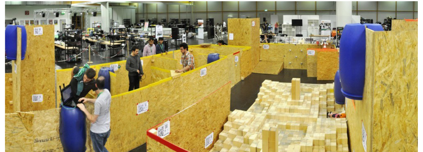
Parcours beim RoboCup Rescue: Im Vordergrund liegt das Stepfield, das für Roboter ein besonders schwieriges Gelände bietet. Vor dem eigentlichen Wettkampf können die Teams zwei Tage lang trainieren.
