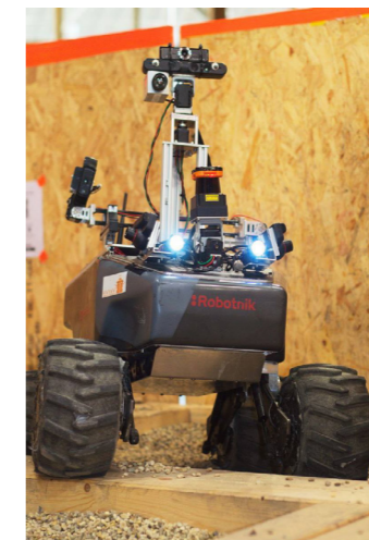
Roboter Simon fährt mit seinen vier Radnabenmotoren beim RoboCup in Magdeburg durch Kies auf der Suche nach Opfern.
