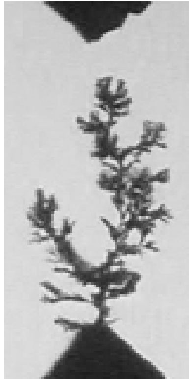
Metall dendriten wachsen von der Kathode (unten) zur Anode (oben)
