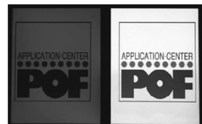
Flachbildschirm AEG CTV 4869 LCD, links Standard Beleuchtung (280 cd/m 2 ), rechts die SBID Hinterleuchtung (1253 cd/m 2 ).
