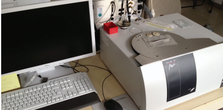
Die DSC 200 F3 Maia®, Hochtemperatur-DSC der Firma Netzsch kann eingesetzt werden zur Qualitätssicherung und Schadensanalyse von Polymeren.
