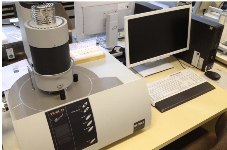
Die DSC 404 F3 Pegasus®, Hochtemperatur-DSC der Firma Netzsch, dient vor allem der Analyse von Eisen-Basis-Werkstoffen. Alle Fotos: Labor Werkstofftechnik
