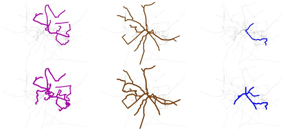
**Abbildung 4:** *Oben:* Kostenminimaler bzw. Linienminimaler Linienplan aufgeschlüsselt nach den drei Transporttypen (von links Stadtbus, Regionalbus, Tram). *Unten:* Fahrzeitminimaler Linienplan aufgeschlüsselt nach den drei Transporttypen. Grau unterlegt kann man das komplette Netzwerk von Potsdam erkennen.
