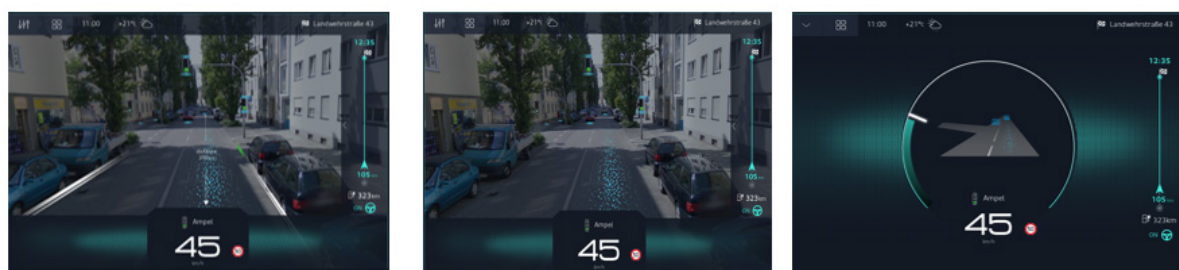
Abbildung 10-17 Umsetzung der letzten Anzeige-Iteration. Vollständige Hervorhebung der Informationen (links), Expertenansicht (ausgewählte Informationen; Mitte), Minimalanzeige (rechts).
