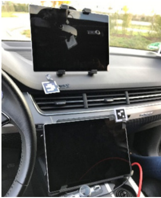
Abbildung 10-6 Anordnung der Bildschirme für das Anzeigekonzept (R-4).
