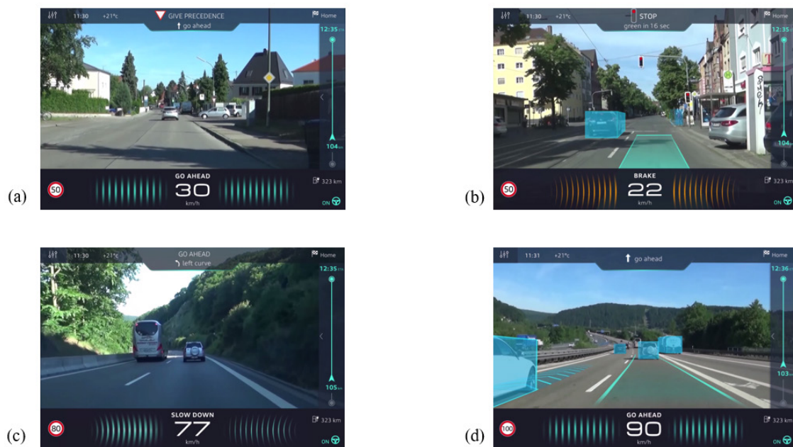
Abbildung 9-1 Varianten des Anzeigekonzeptes als Video-Darstellung. (a) Simple-Konzept im Stadtszenario, (b) AR-Konzept im Stadtszenario, (c) Simple-Konzept im Autobahn-Szenario; (d) AR-Konzept im Autobahn-Szenario.
