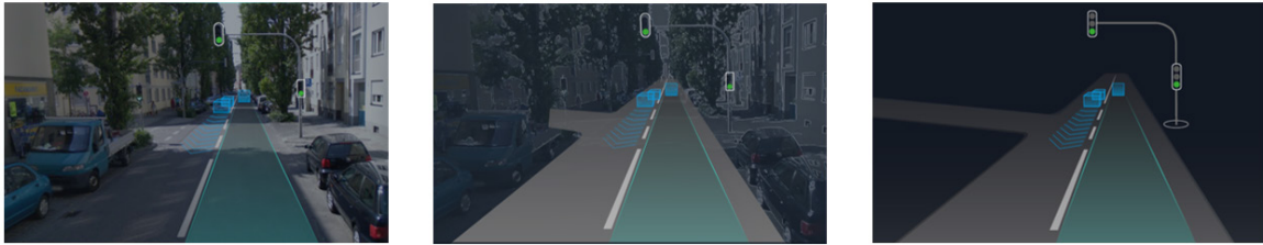
Abbildung 8-3 Darstellungsmöglichkeiten der Außensituation des Realbilds (links), Mischvariante (Mitte) und abstrakter Darstellung (rechts).
