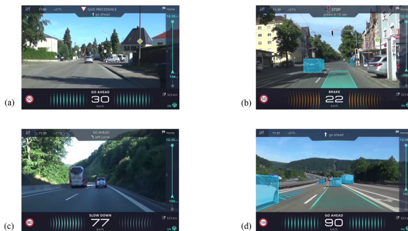
Abbildung F-1 Varianten des Anzeigekonzeptes als Video-Darstellung. (a) Simple-Konzept im Stadtszenario, (b) AR-Konzept im Stadtszenario, (c) Simple-Konzept im Autobahn-Szenario; (d) AR-Konzept im Autobahn-Szenario.
