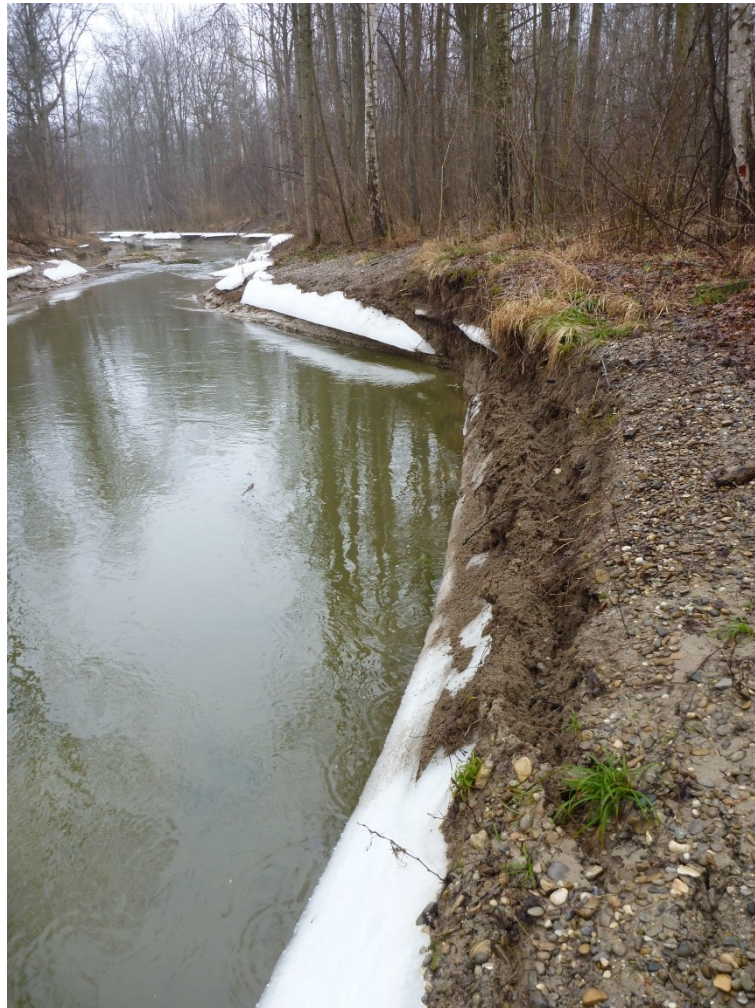
Abb. 7-4: Erosion durch vertikale Eislasten nach fallendem Wasserspiegel am OHB (Foto: Peter Fischer 2012).
