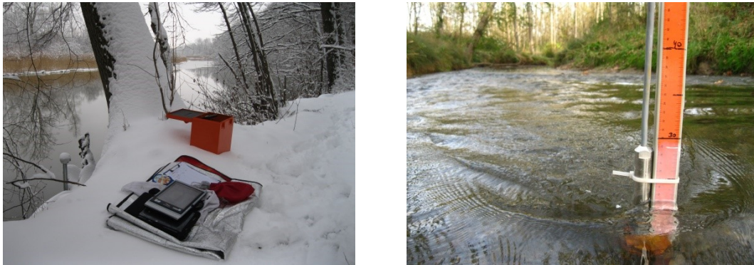
Abb. 5-1: Verschiedene Pegel am Ottheinrichbach. Links: Stationärer Pegel (Pegel 13) an der „Alten Donau“ kurz vor dem Auslesen (Foto: Peter Fischer, 2012). Rechts: temporärer Pegel mit Datenlogger im OHB (Foto: Peter Fischer, 2014).
