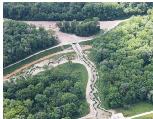
Abb. 4-12: Ausleitungsbauwerk und erster Abschnitt des Ottheinrichbaches. Links: Ausleitungsbauwerk mit Fischpass (Foto: Peter Fischer, 2015). Rechts: Kurze Anbindung zum stark getrübbten Längenmühlbach und „Trogbrücke“. Im Hintergrund der Beckenpass (noch ohne Wasser) und die obere Flutmulde (Foto: Peter Fischer, 2010).
