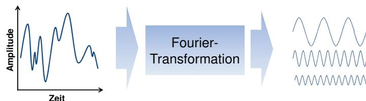
**Abbildung 3.2.5:** Schematische Darstellung der kontinuierlichen Fourier-Analyse
