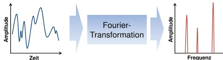
**Abbildung A.4.1:** Schematische Darstellung der Fourier-Analyse
