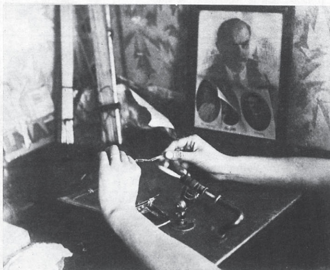
Mit fincken Händen wird ein Glasrohr über der Flamme gedreht. Unter dem Druck eines mit den Füßen betriebenen Blasebalgs wird sie zur Stichflamme, die das Ausziehen des Glasrohrs ermöglicht
