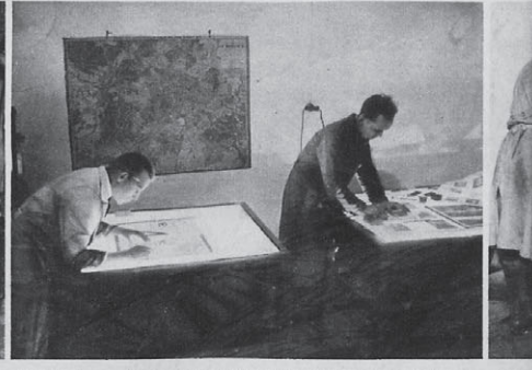
Auf Tischen mit von unten beleuchteten Glasplatten wird das Material der einzelnen Seiten fertiggestellt, die Diapositive und Bronzeabzüge des Textes auf seitengroßen Glas-scheiben zusammenmontiert
