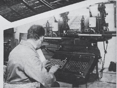
Neuestes Modell einer Monotype-Setz- und Gießmaschine, die zur Herstellung des Textsatzes von Büchern und Zeitungen Verwendung findet
