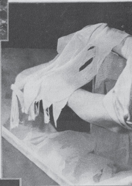
Wie ein hauchdünnes Gewebe läßt sich die Trockenmilch, bevor sie pulverisiert wird, ausbreiten.
