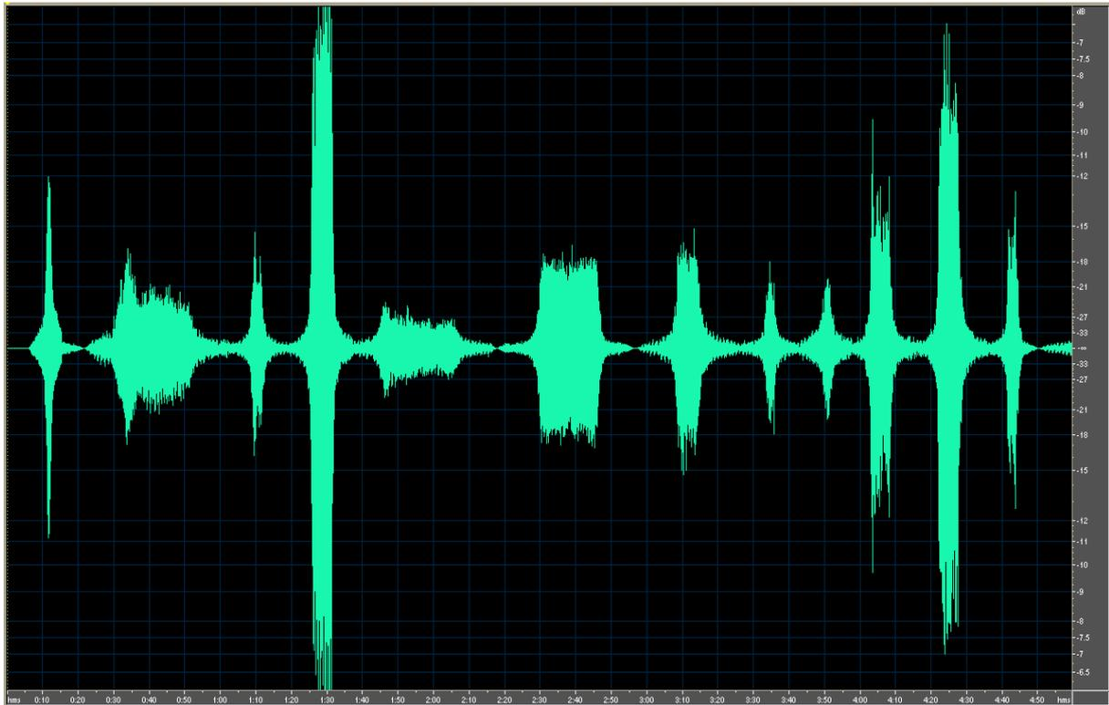
Abbildung 41: Schienenverkehrslärm: diverse Zugdurchfahrten –  $L_{eq}=70$  dB(A)
