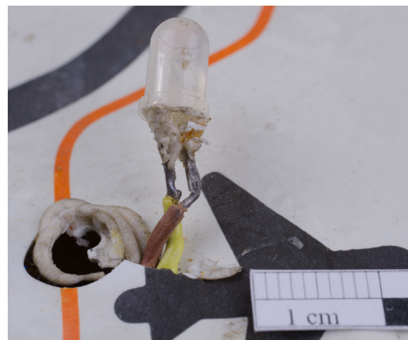
Abb. 75: Segment „J8 Gotha“, Beispiel für eine herausgezogene LED, in der Zustandskartierung durch ein rotes Diodensymbol gekennzeichnet
