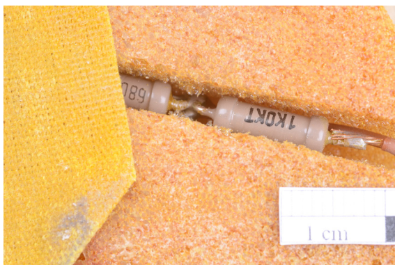
Abb. 83: Widerstandsbauelement, Typ 1 KOKT (für gelbe Dioden)
