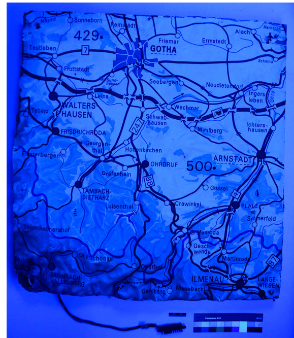
Abb. 55: Segment „J8 Gotha“, Oberseite unter UV-Anregung bei einer Wellenlänge von 254nm, da PVC und Polyurethane erst Wellenlängen ab ca. 330nm absorbieren
