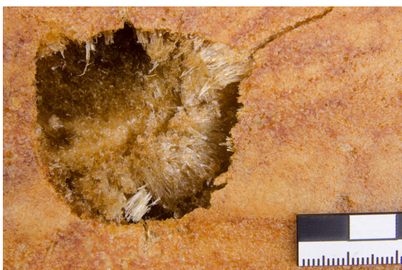
Abb. 67: Segment „J8 Gotha“, Detailaufnahme, Anschäumungspunkt, die Schaumstruktur ist zentriert nach oben ausgerichtet
