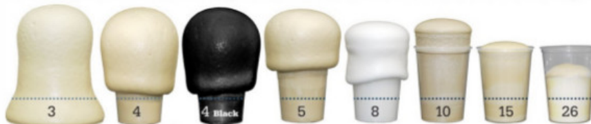
Ausdehnungsbeispiele von 250 ml fertig gemischten Schaums in einem ca. 1 Liter großen Becher
