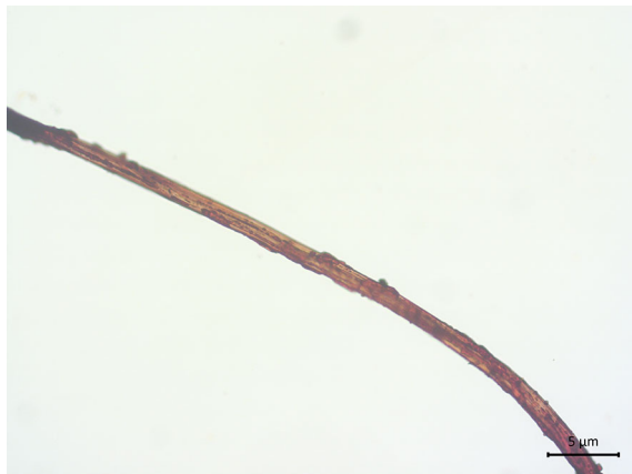
Abb. 145: Faserprobe angefärbt mit Chlorzinkjodlösung nach Herzberg
