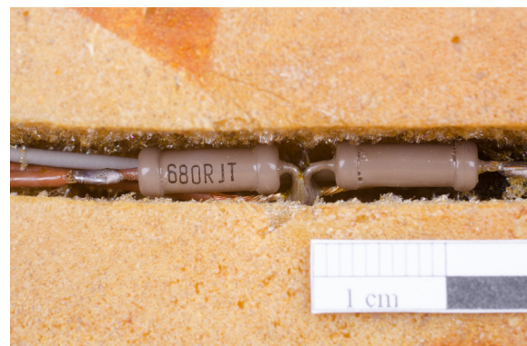
Abb. 84: Widerstandsbauelement, Typ 1 680RJT (für grüne Dioden)
