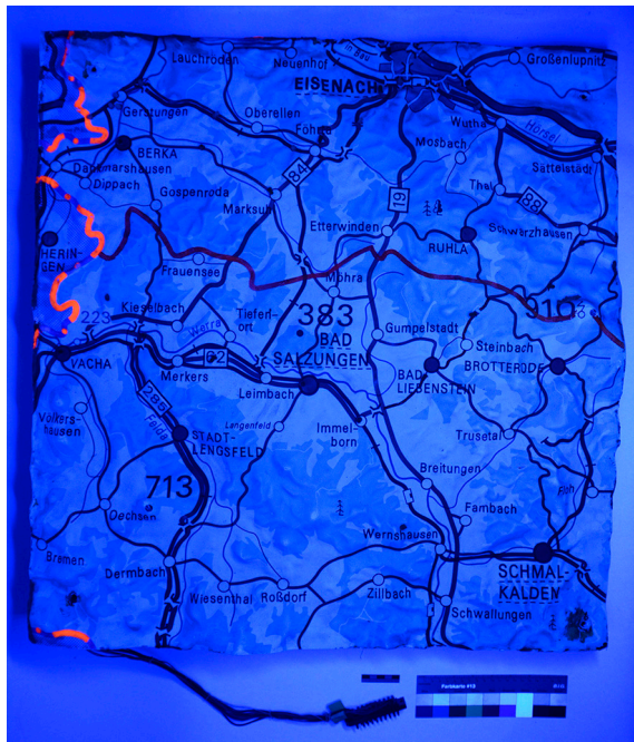
Abb. 54: Segment „K8 Eisenach“, Oberseite unter UV-Anregung bei einer Wellenlänge von 254nm, da PVC und Polyurethane erst Wellenlängen ab ca. 330nm absorbieren
