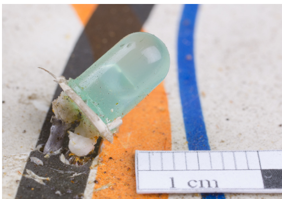
Abb. 74: Segment „J8 Gotha“, Beispiel für eine umgeknickte LED, in der Zustandskartierung durch ein gelbes Diodensymbol gekennzeichnet
