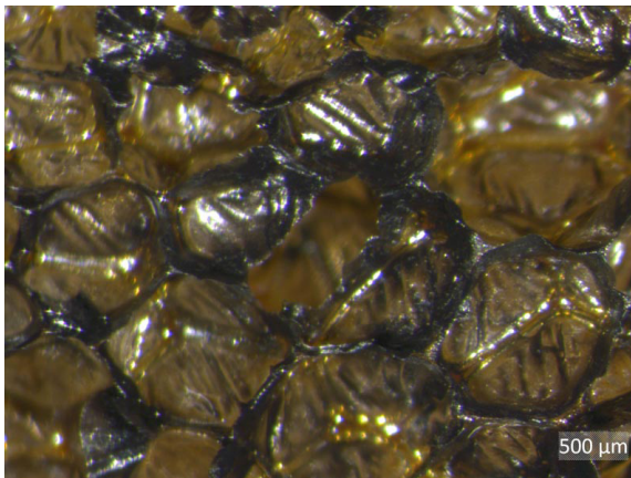
Abb. 115: Zweifacher Auftrag mittels Airbrushpistole, die Filmbildung ist bereits dichter
