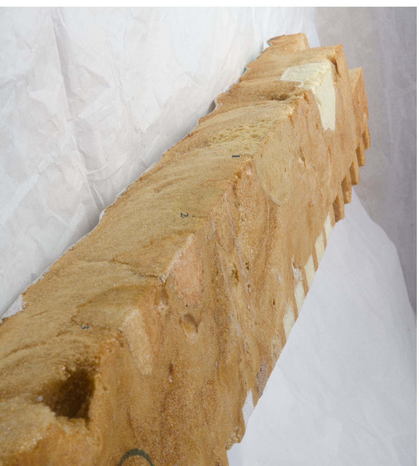
Abb. 101: Probekörper, Unterseite Diese Aufnahme wurde hinzugefügt, da die Retuschen im Streiflicht visuell anders wahrgenommen werden
