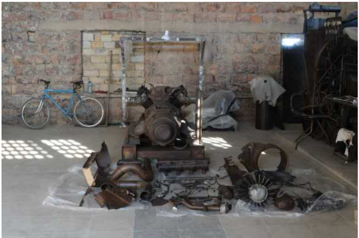
Abb. 37: Demontierte Teile vor der Montage
