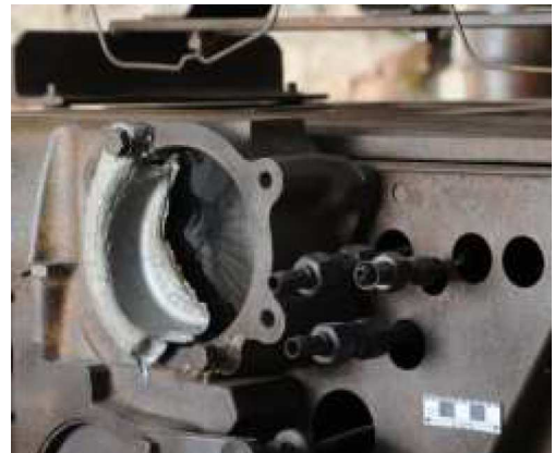
Abb.46: geschmolzene Abdeckung mit Ergänzung
