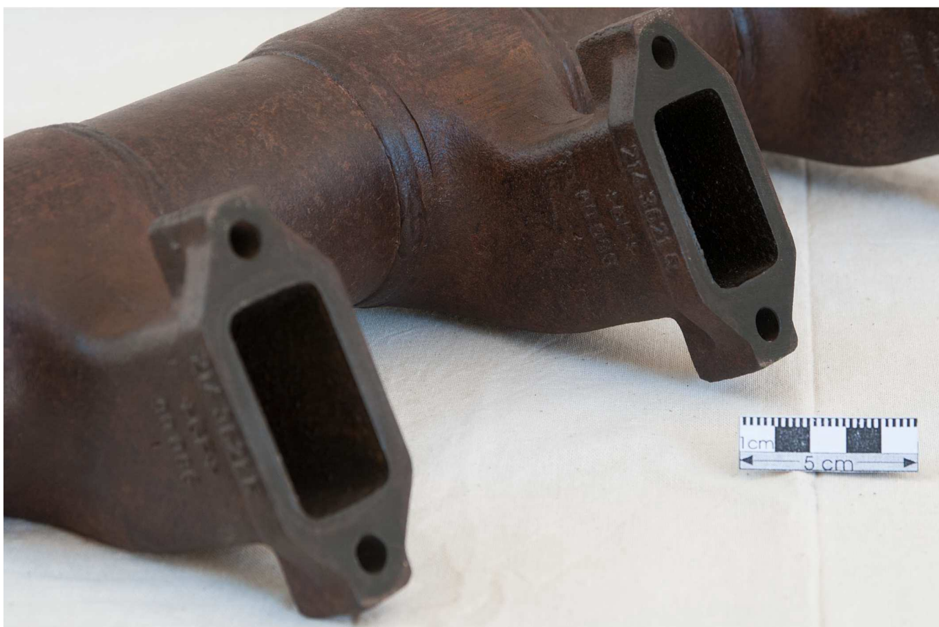
Abb. 55 wie Abb. 54, nach der Reinigung und Konservierung (Foto Jaßmann)
