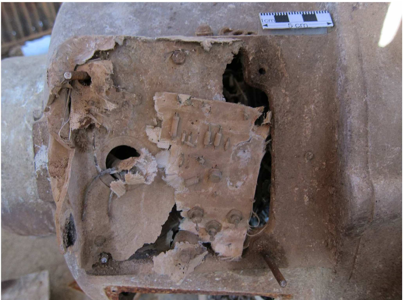
Abb. 14 Leiterplattenfragment, Vorzustand. (Foto Jaßmann)
