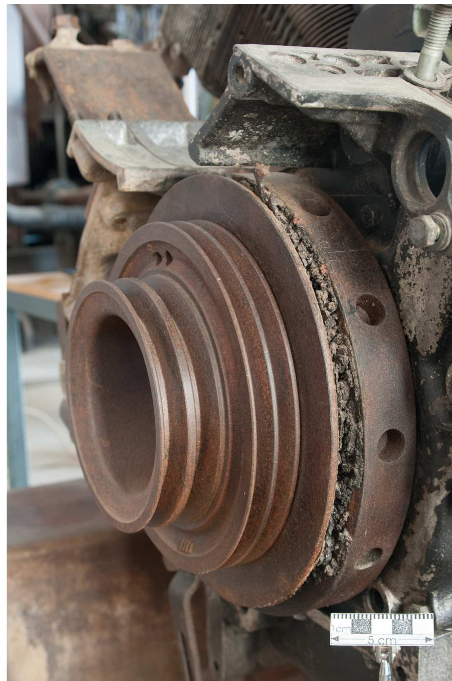
Abb. 42 Riemenscheibe und Reste des Keilriemens gereinigt und konsolidiert. Zustand vor der Restaurierung (vgl. Abb. 23).
