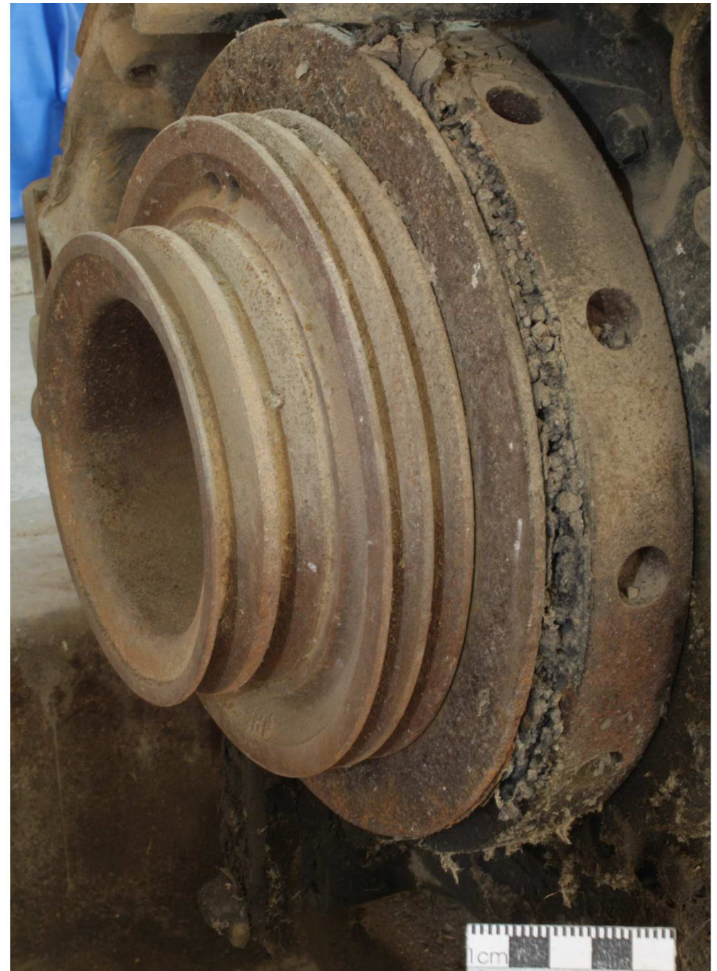
Abb. 23 Riemenscheibe, Reste des verbrannten Keilriemens. (Foto Klein)
