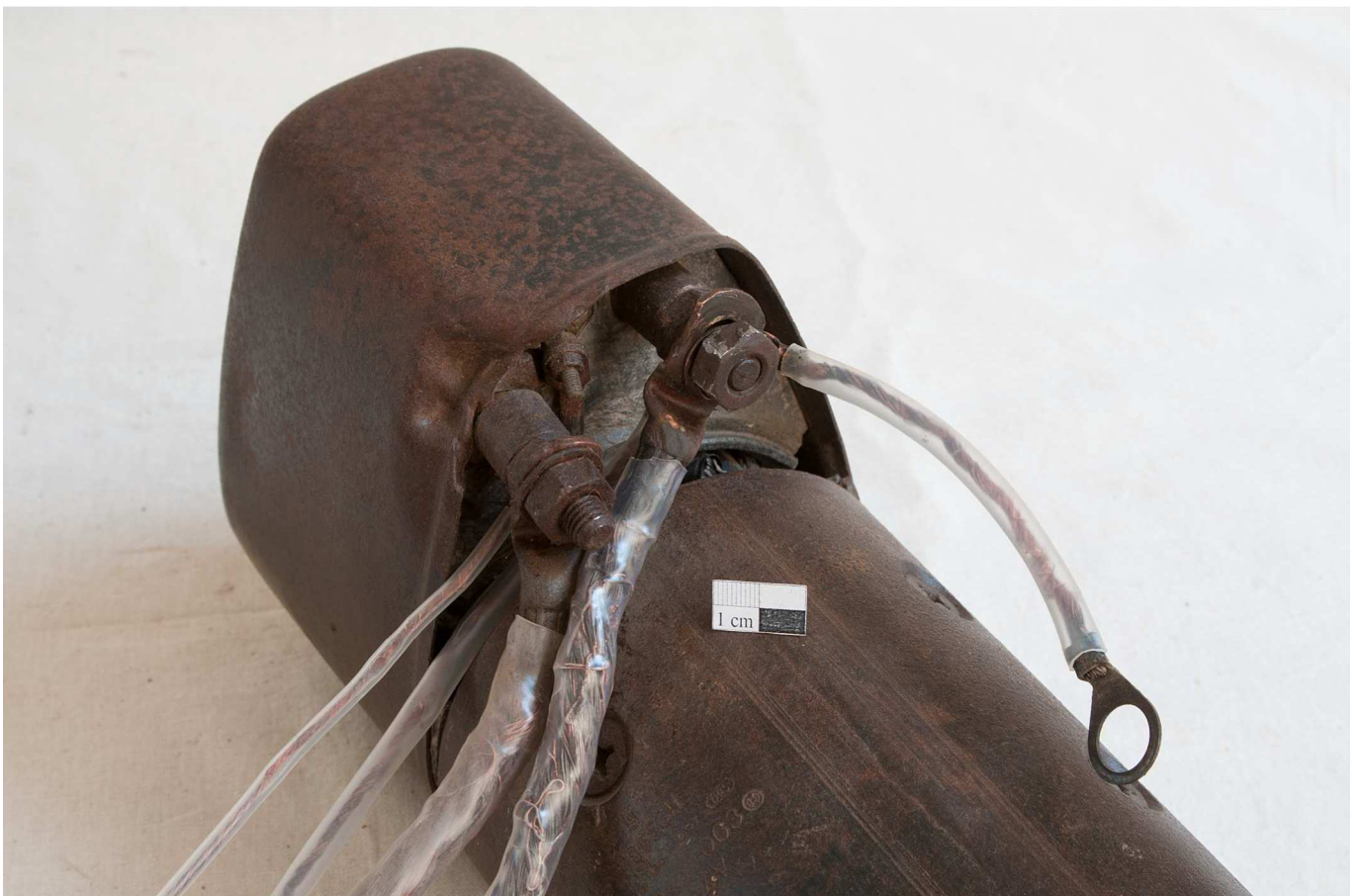
Abb. 50 Anlasser mit Kabeln, nach der Konsolidierung und dem Schrumpfschlauch als Schutz vor Umgebungseinflüssen. (Foto Jaßmann)
