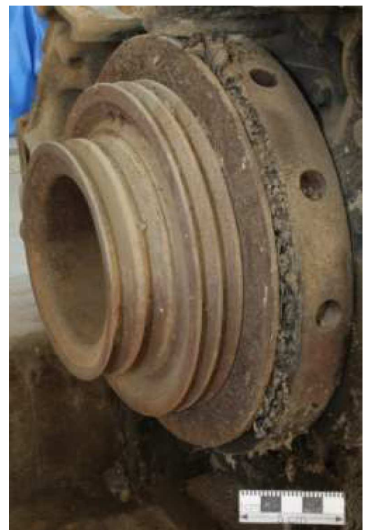
Abb. 23: Riemenscheibe mit Resten des verbrannten Keilriemens
