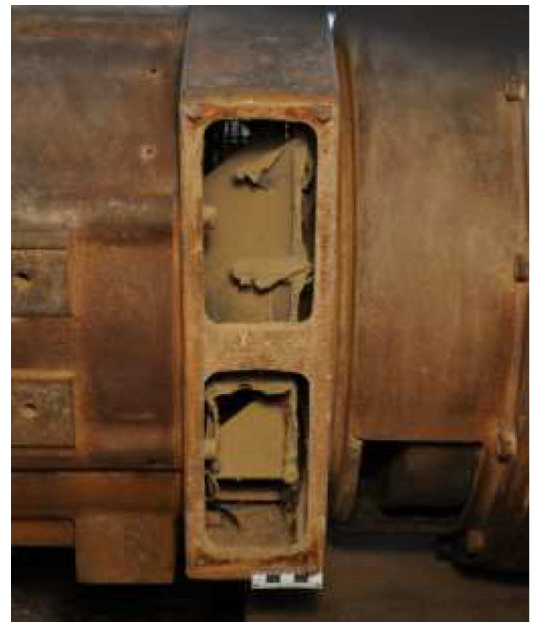
Abb.16: geschmolzenes Lüfterrad im Generator
