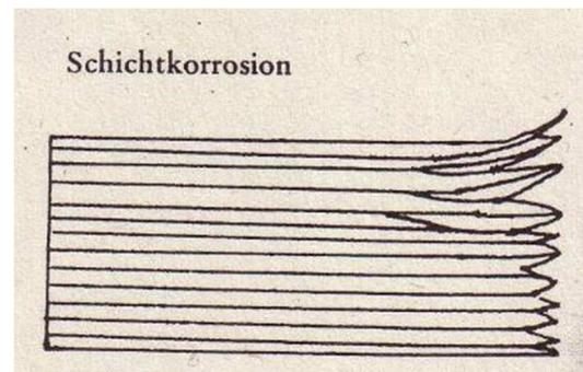
**Abb. 21** Vereinfachte Zeichnung der Schichtkorrosion
