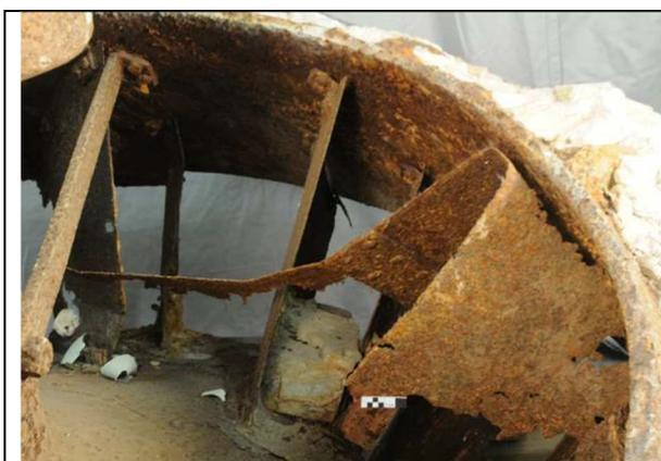
**Abb. 26** Fragment des ursprünglich ringförmigen Grundbleches der Schaufeln
