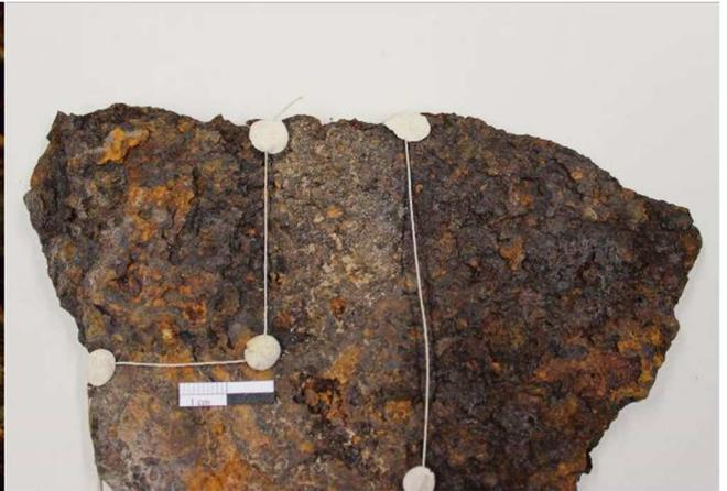
**Abb. 63** Teilweise gestrahltes Schaufelblechfragment; dunklere Bereiche links und rechts wurden bereits gestrahlt
