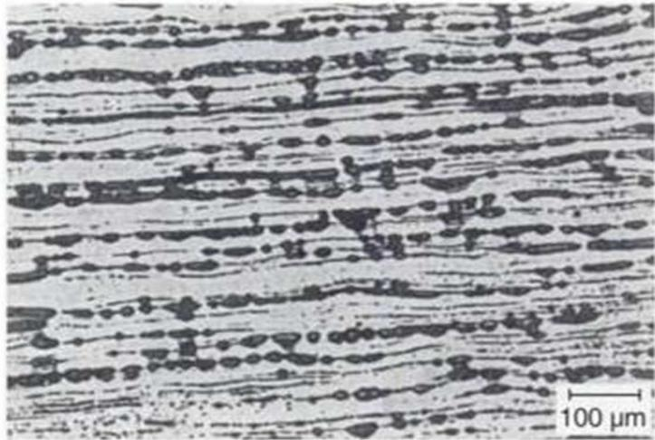
**Abb. 20** Schliff eines Stahles mit einsetzender Schichtkorrosion
