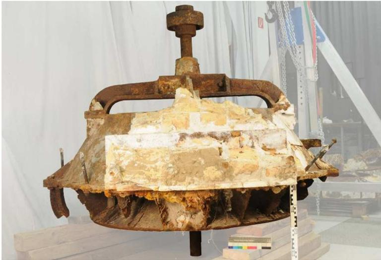
**Abb. 28** Unterseite des Ventilators im demontierten Zustand
