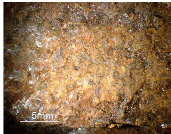
**Abb. 61** Mit dem Dreikantschaber freigelegte Fläche mit Kratzspuren und Materialabrieb, 64-fache Vergrößerung
