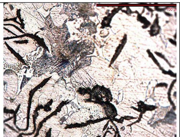
**Abb. 34** Geätzter Schliff des Gusseisens, 500fache Vergrößerung (Lamellengraphit und Perlit-Einschlüsse)
