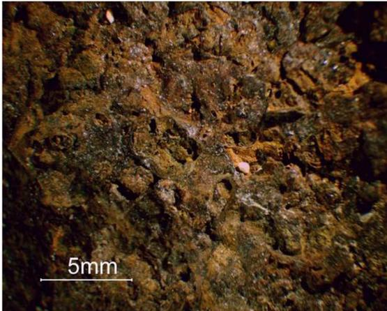
**Abb. 62** Mit Walnussschalen-Granulat gestrahlte Oberfläche, 64-fache Vergrößerung
