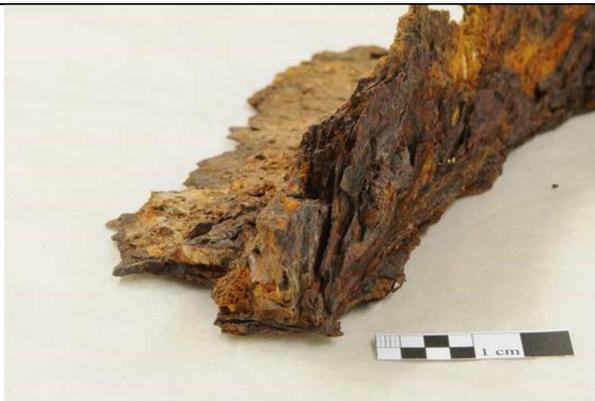
**Abb. 18** Schichtkorrosion am abgefallenen Winkel eines Schaufelbleches
