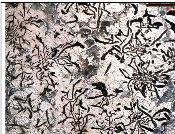
**Abb. 33** Geätzter Schliff des Gusseisens, 200fache Vergrößerung (Lamellengraphit und Perlit-Einschlüsse)
