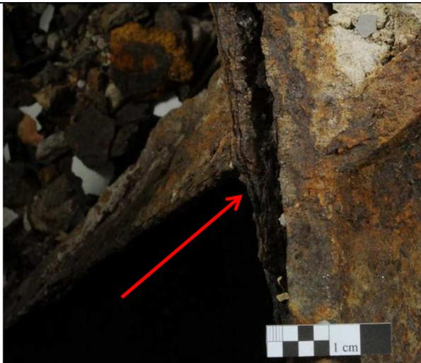
**Abb. 19** Spaltkorrosion zwischen dem Gehäuse und dem ringförmigen Grundblech der Schaufeln
