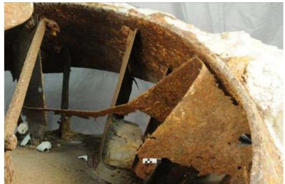
**Abb. 31** Probeentnahmestelle am ringförmigen Grundblech der Schaufeln
