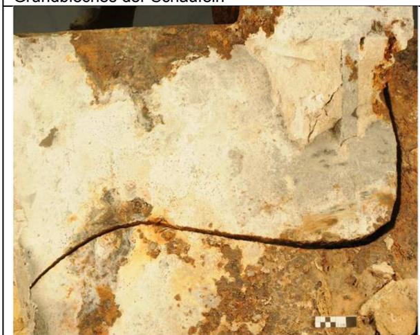
**Abb. 27** Riss im gusseisernen Gehäuse; bei den weißen Ablagerungen auf der Oberfläche handelt es sich um Mörtel
