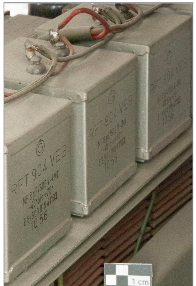
Abb. 436: Detail Rückseite Elektronikgestell, Netzgerät „II“, Beschriftung der Metallpapierkondensatoren
