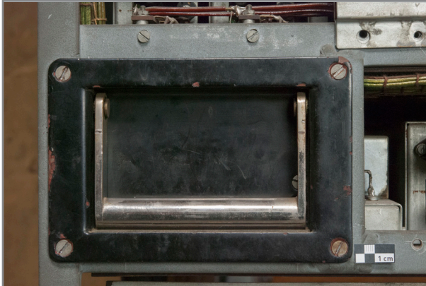
Abb. 403: Detail Rückseite Elektronikgestell, linker Griff zum Herausziehen des Gestells aus dem Holzkorpus
