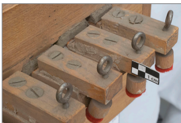
Abb. 124: Detail Pedal Oberseite, Kontakte Pedalmechanik, graue & weiße Auflagerungen & Verkrustungen, Metallösen der Kontakte verbogen
