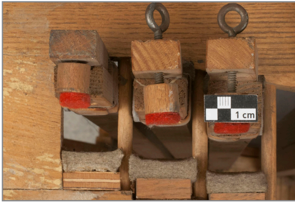
Abb. 149: Detail Orgelseite Pedal, Führung der Ganzton-Pedaltasten
