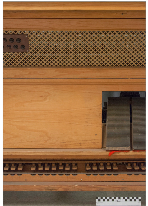
Abb. 79 & 80: Übersicht Fußraum der Orgel mit den drei Teilbereichen (vonu) Gitterelement, Schwellerwand und Pedalmechanik, Teilansichten links und Mitte links
