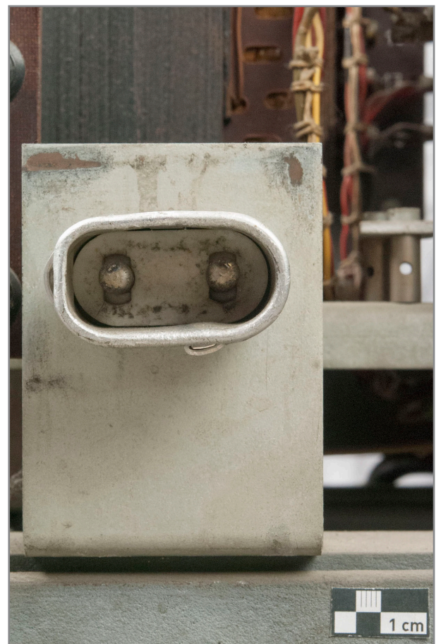
Abb. 426: Detail Rückseite Elektronikgestell, Netzgerät „II“ Netzstecker von vorne
