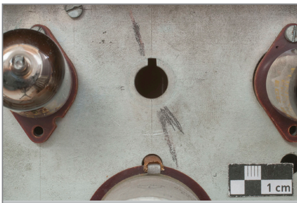
Abb. 316: Detail Vorverstärker Oberwerk, Bezeichnung eines Loches im Chassis mit mehreren Bleistift „-“
