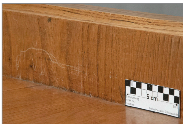
Abb. 196: Kratzspuren parallel zur Deckelbewegung während des Öffnens
