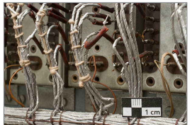
Abb. 580: Detail Spielseite Elektronikgestell, gelöstes Kabel des Tastsystems „d 1 d 1 “,
