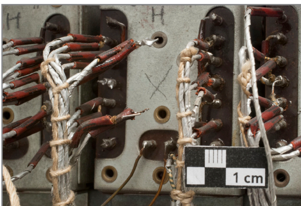
Abb. 565: Detail Spielseite Elektronikgestell, abgelöste Kabel des Tastsystems Hauptwerk „c 3 c #3 “
