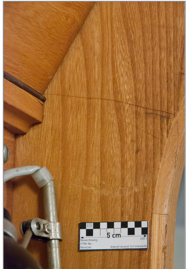
Abb. 102: Detail Fußraum, rechte Innenseite des Seitenteils, dunkel verfarbte, aber auch helle Kratzer
