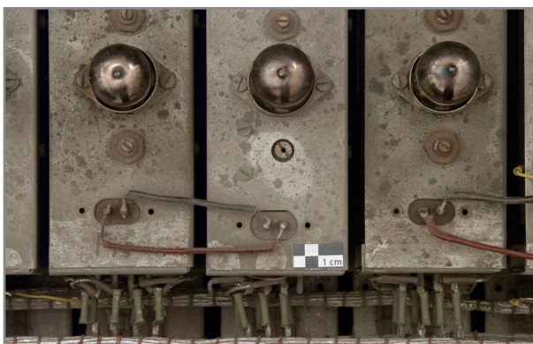
Abb. 356: Detail Oberseite Elektronikgestell, Frequenzteilerkette „Eis“ [sic], rückwärtige Kante, Aufhellung der Auflagerungen um den Regelwiderstand der letzten Röhre
