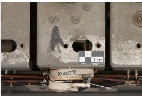
Abb. 238: Detail Oberseite Elektronikgestell, Frequenzteilerketten, Bezeichnung des Chassis mit schwarz „A“
