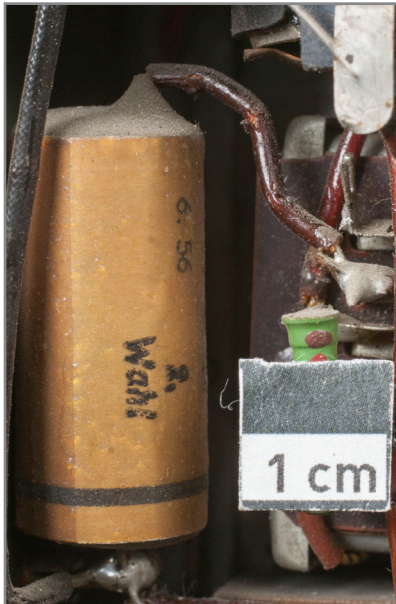
Abb. 453: Detailansicht linke Seite des Elektronikgestells, zweites Chassis der Frequenzteilerkette „C“, Kondensator Beschriftet „2. Wahl“
