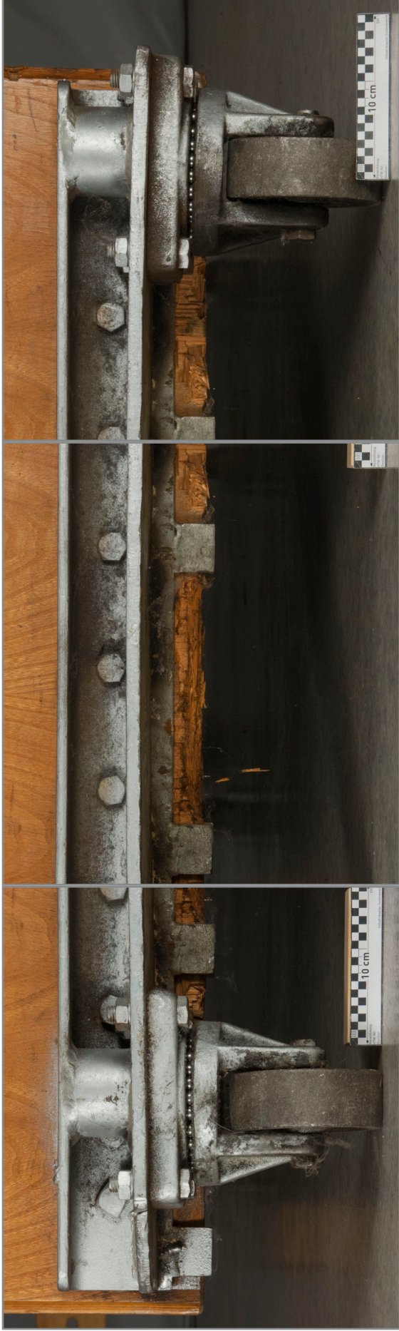
Abb. 183-185: Seitenansicht des rechten Fußes mit Rollen, Abnutzungsspuren an der Unterkante des Holzkorpus, silberne Farbe auf Holz des Seitenteils
