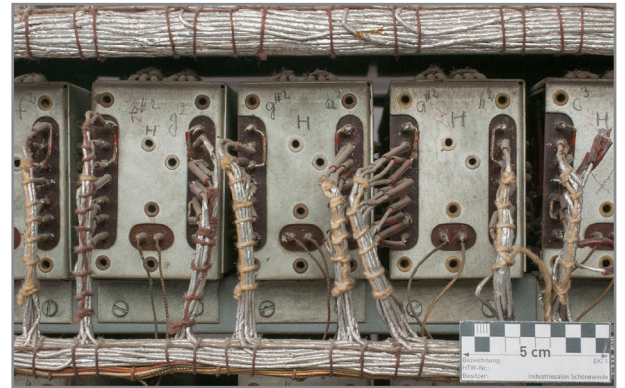
Abb. 562: Detail Spielseite Elektronikgestell, Tastsysteme Hauptwerk „f #2 g 2 “, „g #2 a 2 “ und „a #2 h 2 “, sehr eingedrückte Kabelbäume erkennbar
