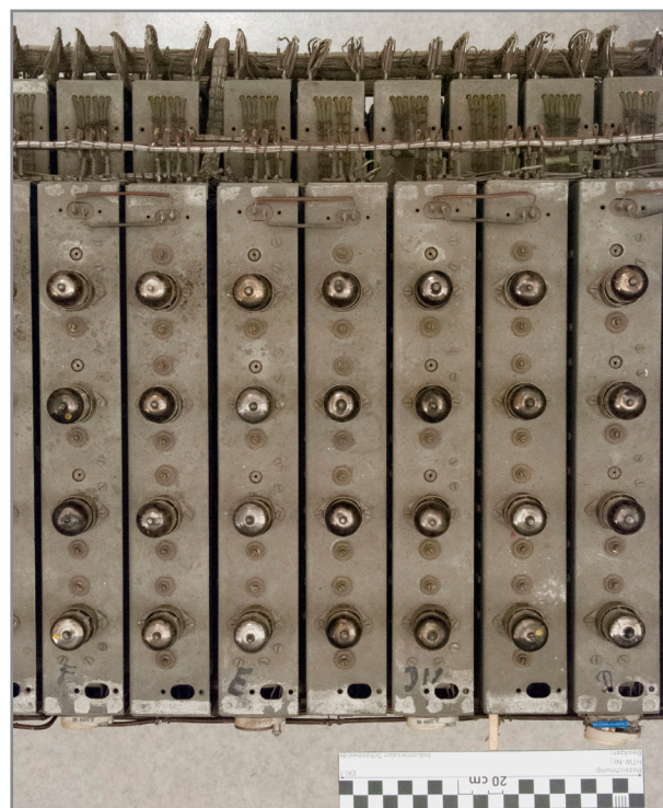
Abb. 325: Detail Oberseite Elektronikgestell, vor der Trockenreinigung, je zwei Chassis der Frequenzteilerketten der Grundtöne „F“, „E“ und „Dis“, silberne Farbaufträge nahe der vorderen und rückwärtigen Kanten der Frequenzteilerchassis
