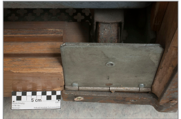
Abb. 252: Detail Rückseite, rechts unten, hochgeklappte Metallrampe zum Ausfahren des Elektronikgestells
