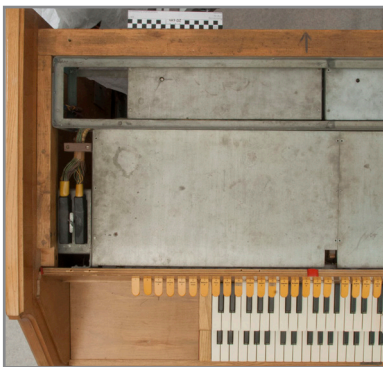
Abb. 216-218: Deckel geöffnet, Sicht auf die Filterabdeckungen unten sowie die Vorverstärker oben im Bild
