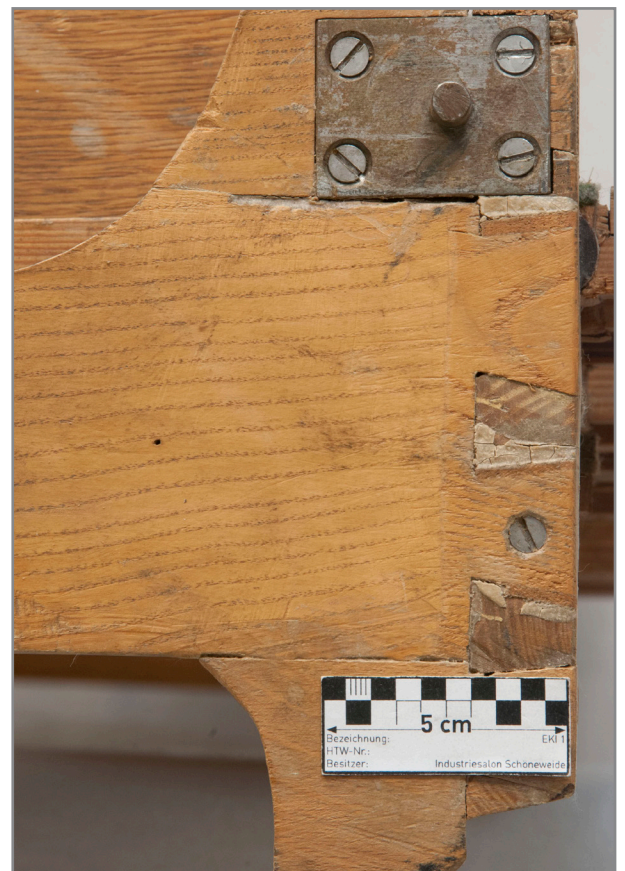
Abb. 130: Detail Pedal rechte Seite, Fuß Orgelseite, kleinere Ausbrüche im Holz um den Einhängedorn, Klebstoffüberschüsse in der Schwalbenschwanzverbindung, Korrosion auf Einhängedorn & zugehöriger Metallplatte
