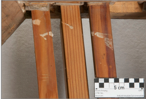
Abb. 137: Detail Unterseite Pedaltasten, Leimspuren
