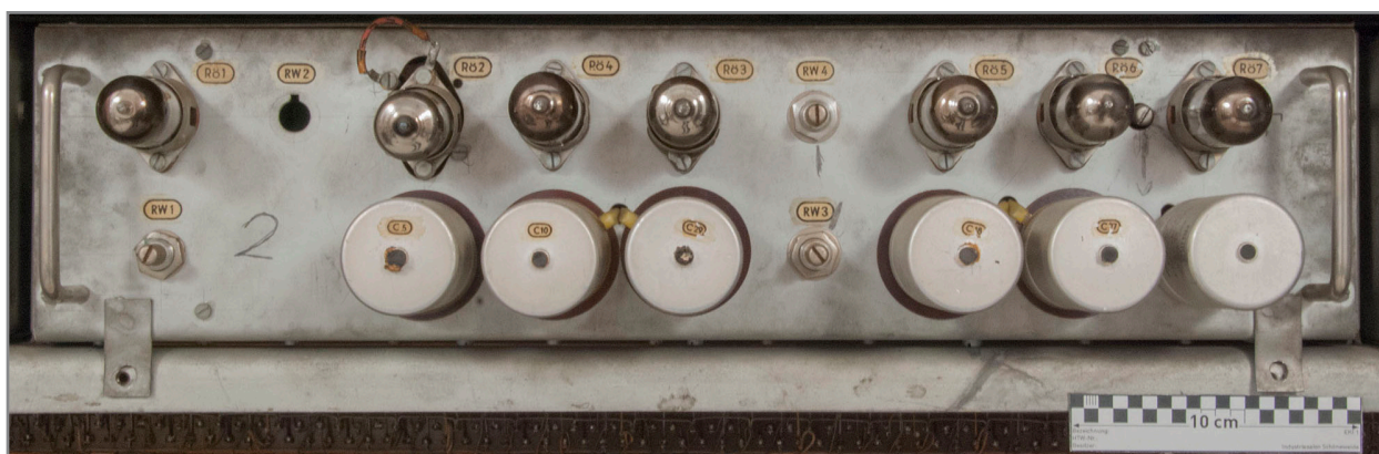
Abb. 310: Gesamtansicht Vorverstärker mittig, mit Tremulant für das Hauptwerk, Röhren ECC 82, 81, 5 x 82, sechs Elektrolytkondensatoren
