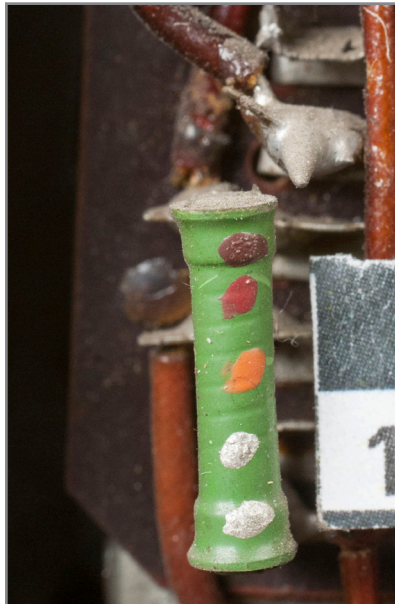
Abb. 454: Detailansicht linke Seite des Elektronikgestells, zweites Chassis der Frequenzteilerkette „C“, Widerstand
