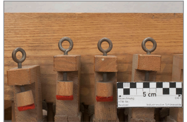
Abb. 152: Detail Orgelseite Pedal, Mechanik, erkennbare Unregelmäßigkeit der Tastenaufhängungen
