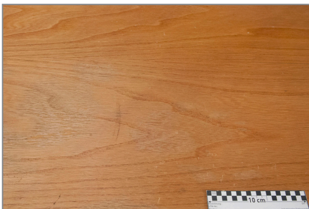
Abb. 209: Detail Deckel Wölbung Innenseite, Eindrücke und Holzverfärbungen in der Wölbung des Deckels
