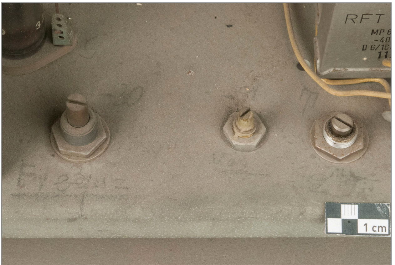
Abb. 439: Detail Rückseite Elektronikgestell, Netzgerät „III“, drei Regelwiderstände mit Bleistiftbezeichnungen „Frequenz“ und „-30“, „Vo[x]“ und „-5V“ sowie „T“, vor der Trockenreinigung
