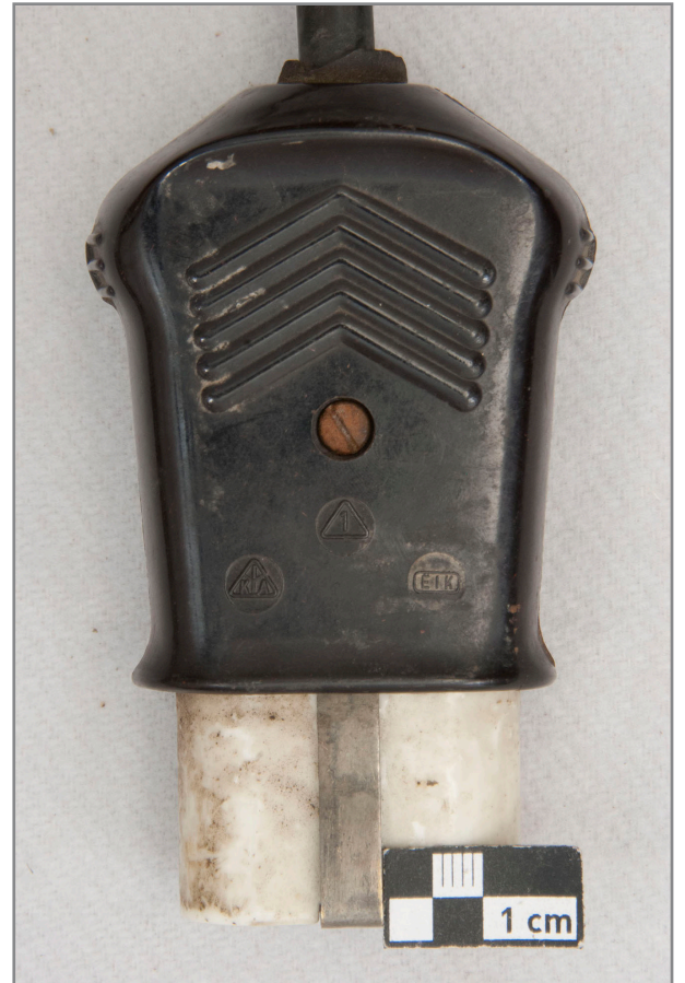
Abb. 604: Detail Netzkabel, „Heißgeräte-Stecker“, mit Symbolen „1 [in Dreieck]“, „E K [in Dreieck]“ und „E I K [in Rechteck]“
