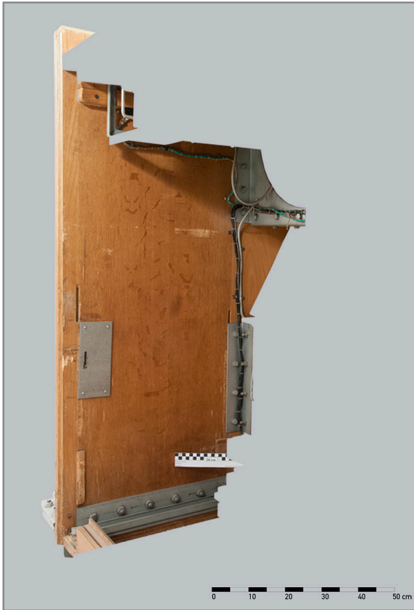
Abb. 271: Gesamtansicht des rechten Seitenteils von innen, erkennbar die grauen Metallstützen oben und rechts, die Schiene für das Elektronikgestell unten sowie die Platte zur Verriegelung des Gestells im Korpus links
