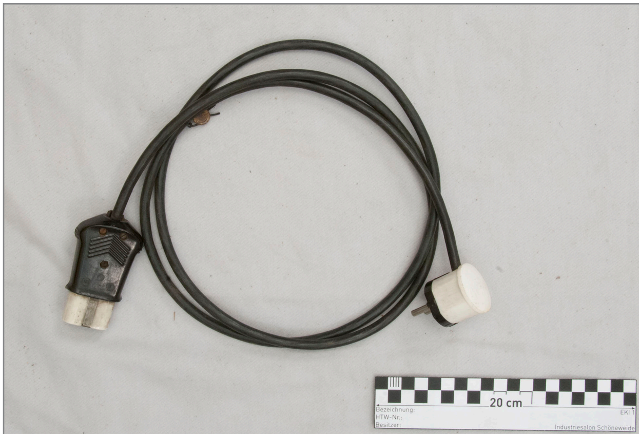
Abb. 599: Gesamtansicht Netzkabel mit „Heißgerätestecker“ (orgelseitig) und „Schuko-Stecker“ (Netz)
