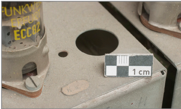
Abb. 360: Detail Oberseite Elektronikgestell, Sammelschienenverstärker Hauptwerk, rückwärtige Kante, blätterndes Bezeichnungsklebchen und Auflagerungen vor der Trockenreinigung
