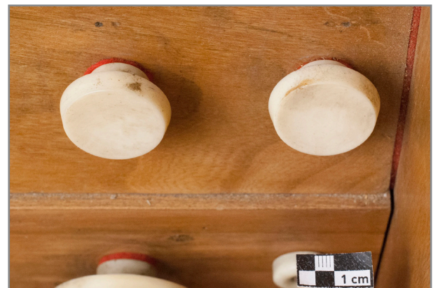
Abb. 16: Detail Schaltergruppe rechter Manualbereich: Auflagerungen an Drehreglern, gekittete Bohrungen im Holz hinter allen drei Drehknöpfen
