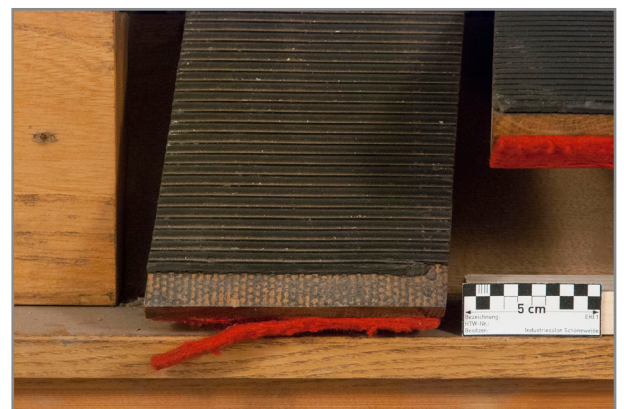
Abb. 110: Detail Fußraum, linker Schweller, Textilaufgabe teils lose, flächige Fehlstelle in der Elastomermatte, feine & grobe Auflagerungen
