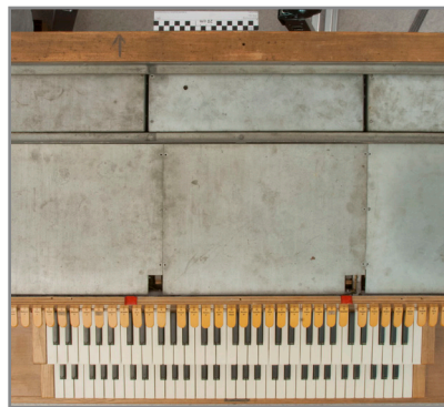
Abb. 216-218: Deckel geöffnet, Sicht auf die Filterabdeckungen unten sowie die Vorverstärker oben im Bild
