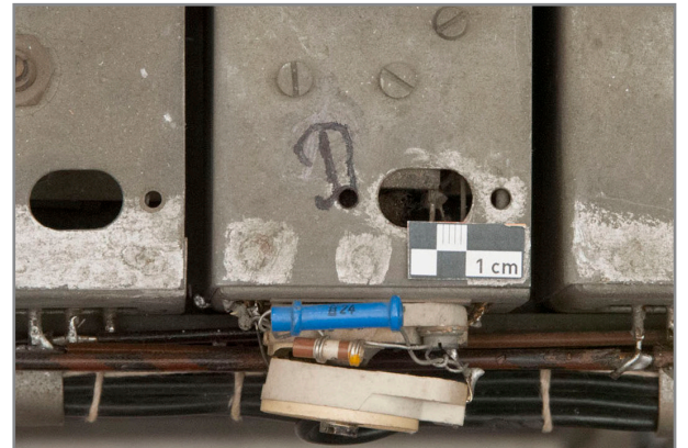
Abb. 345: Detail Oberseite Elektronikgestell, Frequenzteilerketten, Bezeichnung des Chassis mit schwarz „D“
