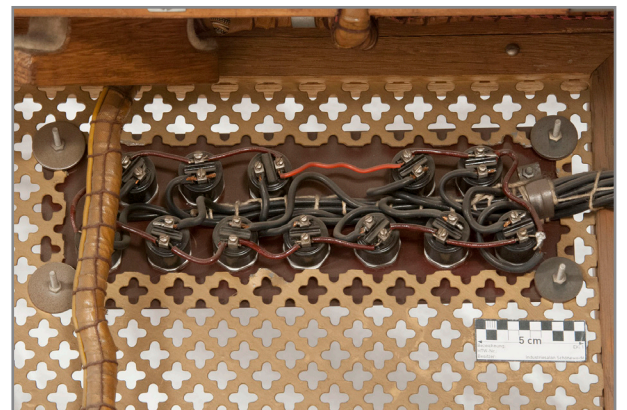
Abb. 282: Detail Innenraum Gitter, Verkabelung der Tontestknöpfe
