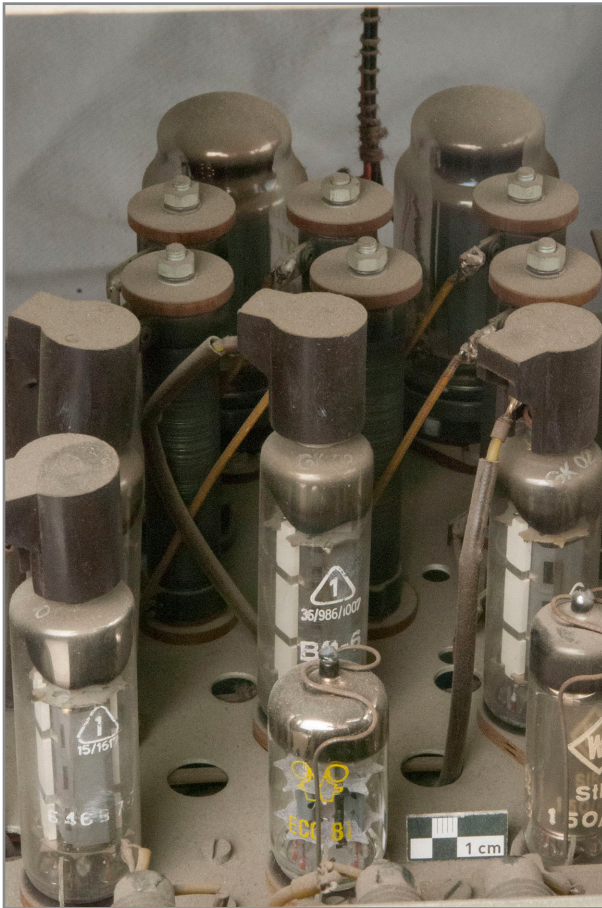
Abb. 443: Detail Rückseite Elektronikgestell, Netzgerät „I“, Elektronenröhren EL 81, ECC 81 und Str 150/30, in Hintergrund die EYY 13
