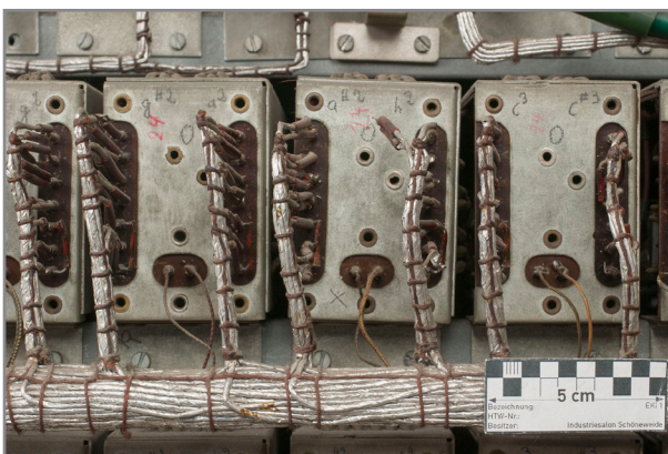
Abb. 549: Detail Spielseite Elektronikgestell, Tastsysteme Oberwerk „g#2 a2“, „a#2 h2“ und „c3 c#3“
