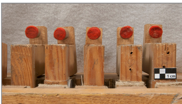
Abb. 155: Detail Orgelseite Pedal, Mechanik von unten, Bleistiftbeschriftung (überkopf) „c“, „cis“, „d“, „dis“, „e“
