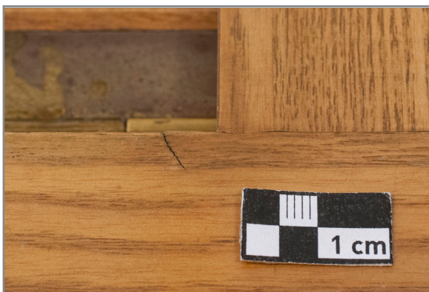
Abb. 9: Detail Notenhalter Vorderseite: Riss im Holz in unterer Querstrebe neben rechter mittlerer Längsstrebe
