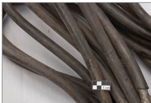
Abb. 618: Detail Tonkabinettkabel kurz I, Druckstellen am Kabel durch Zusammenbinden mit isoliertem Draht
