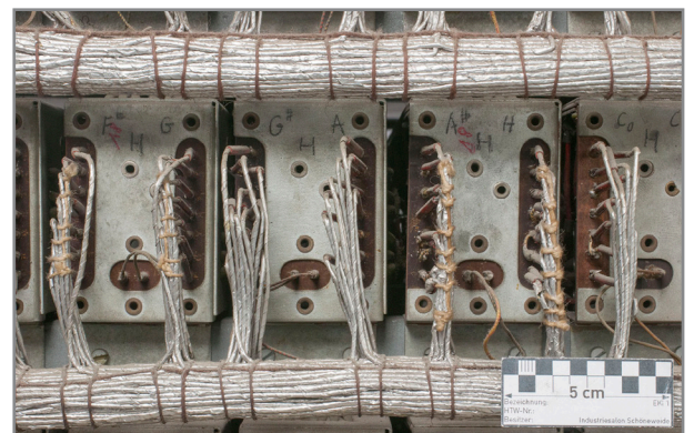
Abb. 556: Detail Spielseite Elektronikgestell, Tastsysteme Hauptwerk „F # G“, „G # A“ und „A # H“, Kabel des zweiten ohne Kabelbaumbindung
