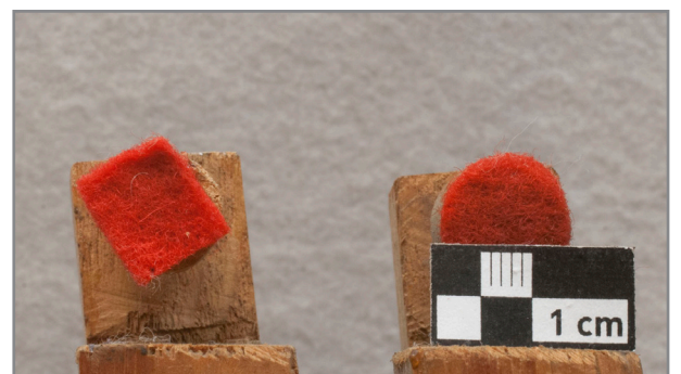
Abb. 156: Detail Orgelseite Pedal, Mechanik von unten, ergänzter Textildämpfer
