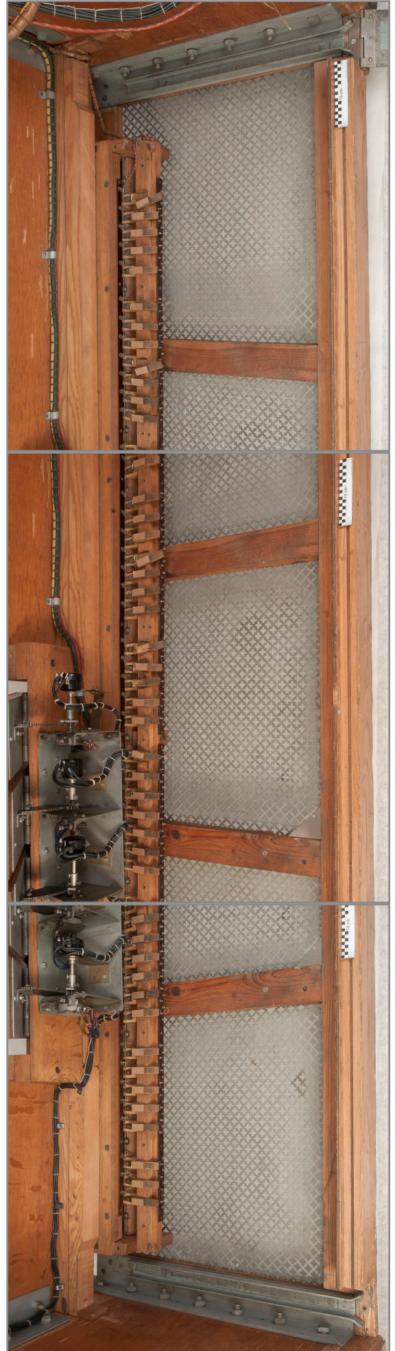
Abb. 305-307: Gesamtansicht Innenraum Boden, drei Gitter durch Holzstege voneinander getrennt, mit Pedalkontakten und Schwellern im Hintergrund
