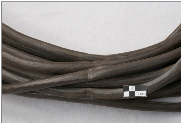
Abb. 608: Detail Tonkabinettkabel lang, Abdruck im Kabel nach Entfernung der Kabelbinder
