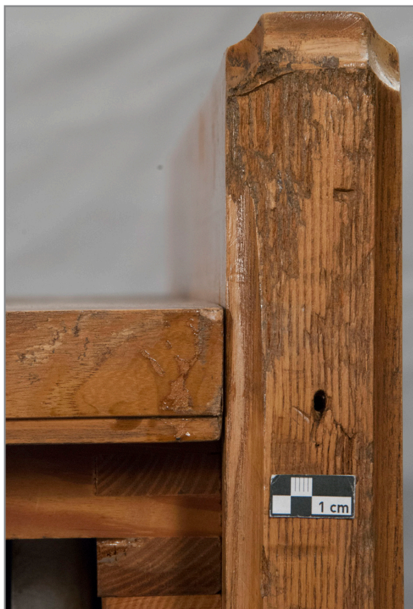
Abb. 247: Detail Rückseite, oberer Abschluß des linken Seitenteils, Abtrag der Holzoberfläche, an der rückwärtigen Kante des Deckels Verkrustung eines Überzugs
