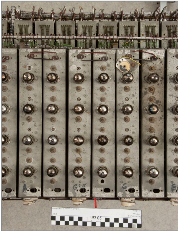
Abb. 330: Detail Oberseite Elektronikgestell, nach der Trockenreinigung, je zwei Chassis der Frequenzteilerketten der Grundtöne „A“, „Gis“ und „G“
