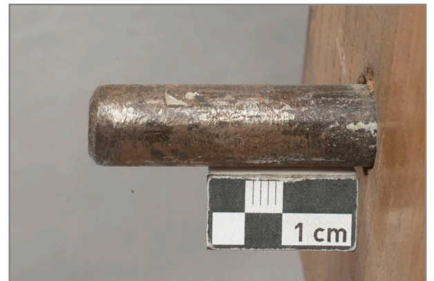
Abb. 135: Detail Pedal rechte Seite, hinterer Metalldorn zum Einhängen des Pedals im Fußraum der Orgel, verschiedene Korrosionsbilder
