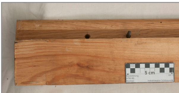
Abb. 244: Detail Leiste zwischen Deckel und Manualbereich zur Spielseite, linke Seite von unten, Bohrungen zur Befestigung mit Schrauben
