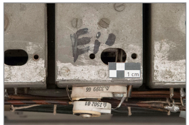
Abb. 341: Detail Oberseite Elektronikgestell, Frequenzteilerketten, Bezeichnung des Chassis mit schwarz „Eis“ [sic]
