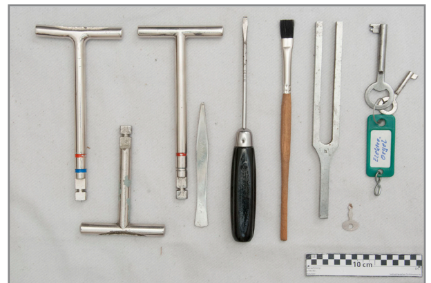
Abb. 628: Detailansicht Zubehör, drei Schlüssel für Tonkabinette, eine Pinzette, ein Schraubendreher, ein Pinsel, Schlüssel für das Gitterbrett im Fußraum sowie das Manual, ein Schlüssel unbekannter Funktion
