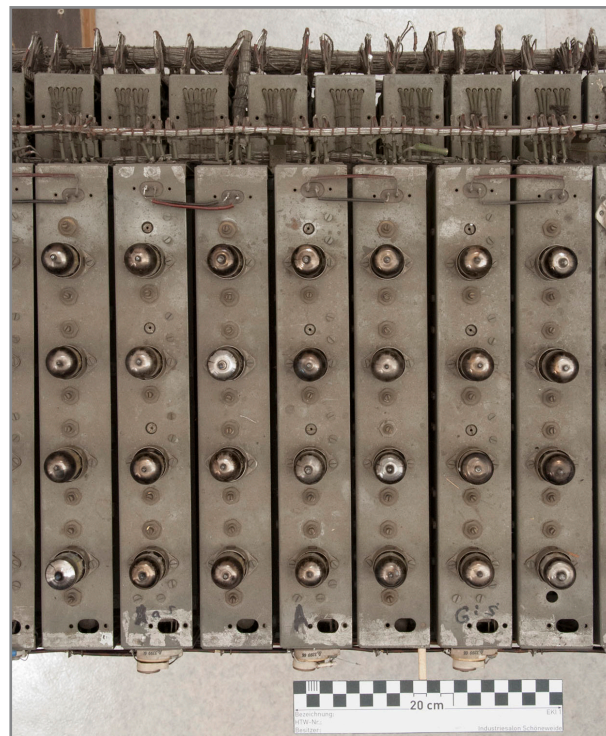
Abb. 323: Detail Oberseite Elektronikgestell, vor der Trockenreinigung, ein Chassis der Frequenzteilerkette des Grundtons „H“, je zwei Chassis der Grundtöne „Aas“, „A“ und „Gis“, silberne Farbaufträge nahe der vorderen und rückwärtigen Kanten der Frequenzteilerchassis
