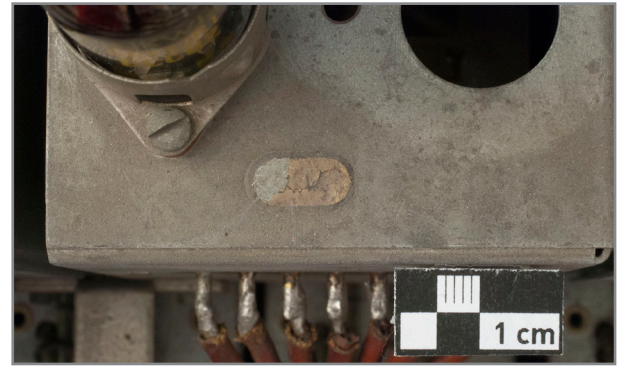
Abb. 359: Detail Oberseite Elektronikgestell, Sammelschienenverstärker Oberwerk, rückwärtige Kante, blätterndes Bezeichnungsklebchen und Auflagerungen links vor der Trockenreinigung, rechts danach
