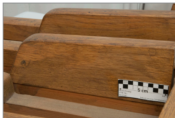
Abb. 123: Detail Pedal Oberseite, Halbtontaste Orgelseite, dunkle Auflagerung in Tropfenmuster ausgehärtet
