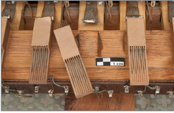
Abb. 301: Detail Innenraum Spielseite, lose Bürstenkontakte des Pedals nach der Trockenreinigung, dunkle Klebstoffrückstände erkennbar
