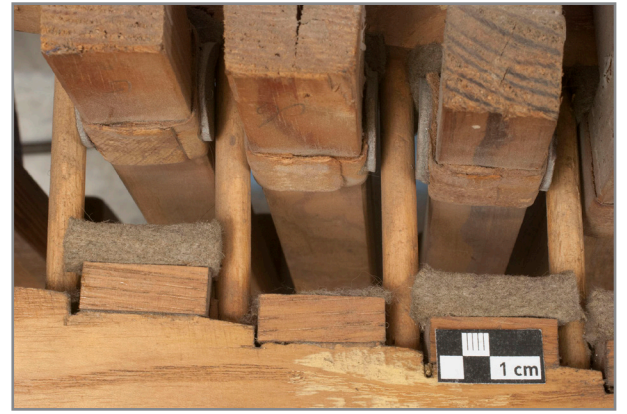
Abb. 150: Detail Orgelseite Pedal: Führung der Ganzton-Pedaltasten, Bleistiftbeschriftung (überkopf) „d“, „dis“, „e“
