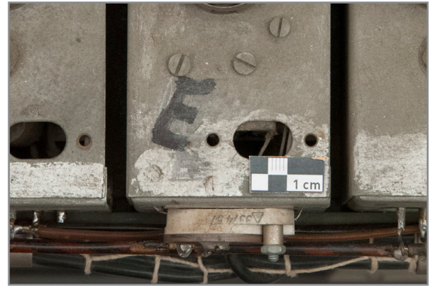
Abb. 343: Detail Oberseite Elektronikgestell, Frequenzteilerketten, Bezeichnung des Chassis mit schwarz „E“
