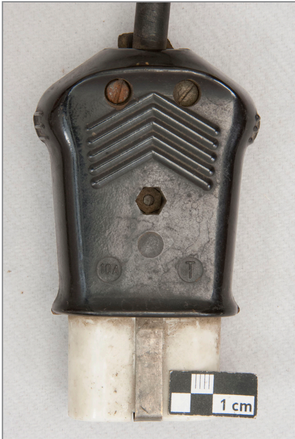
Abb. 603: Detail Netzkabel, „Heißgeräte-Stecker“, mit Symbolen „10 [Dreieck]“ und „T“
