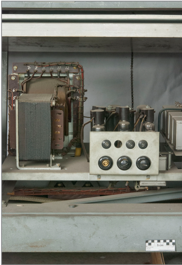
Abb. 423: Detail Rückseite Elektronikgestell, Netzgerät „I“, links Transformatoren, mittig Röhren EL 81, rechts Metallpapierkondensatoren
