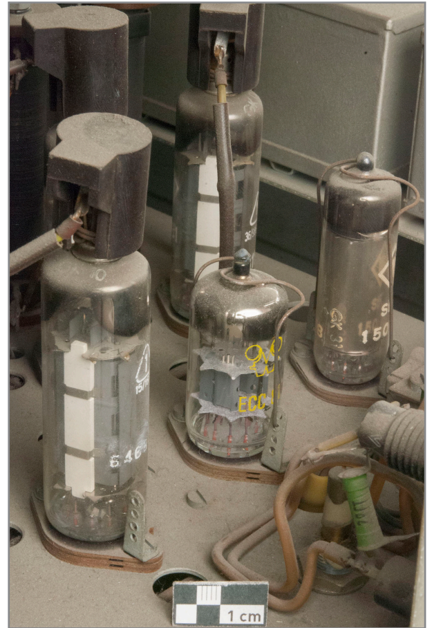
Abb. 444: Detail Rückseite Elektronikgestell, Netzgerät „I“, Elektronenröhren EL 81, ECC 81 und Str 150/30, hinten Metallpapierkondensatoren des Netzgeräts „IV“
