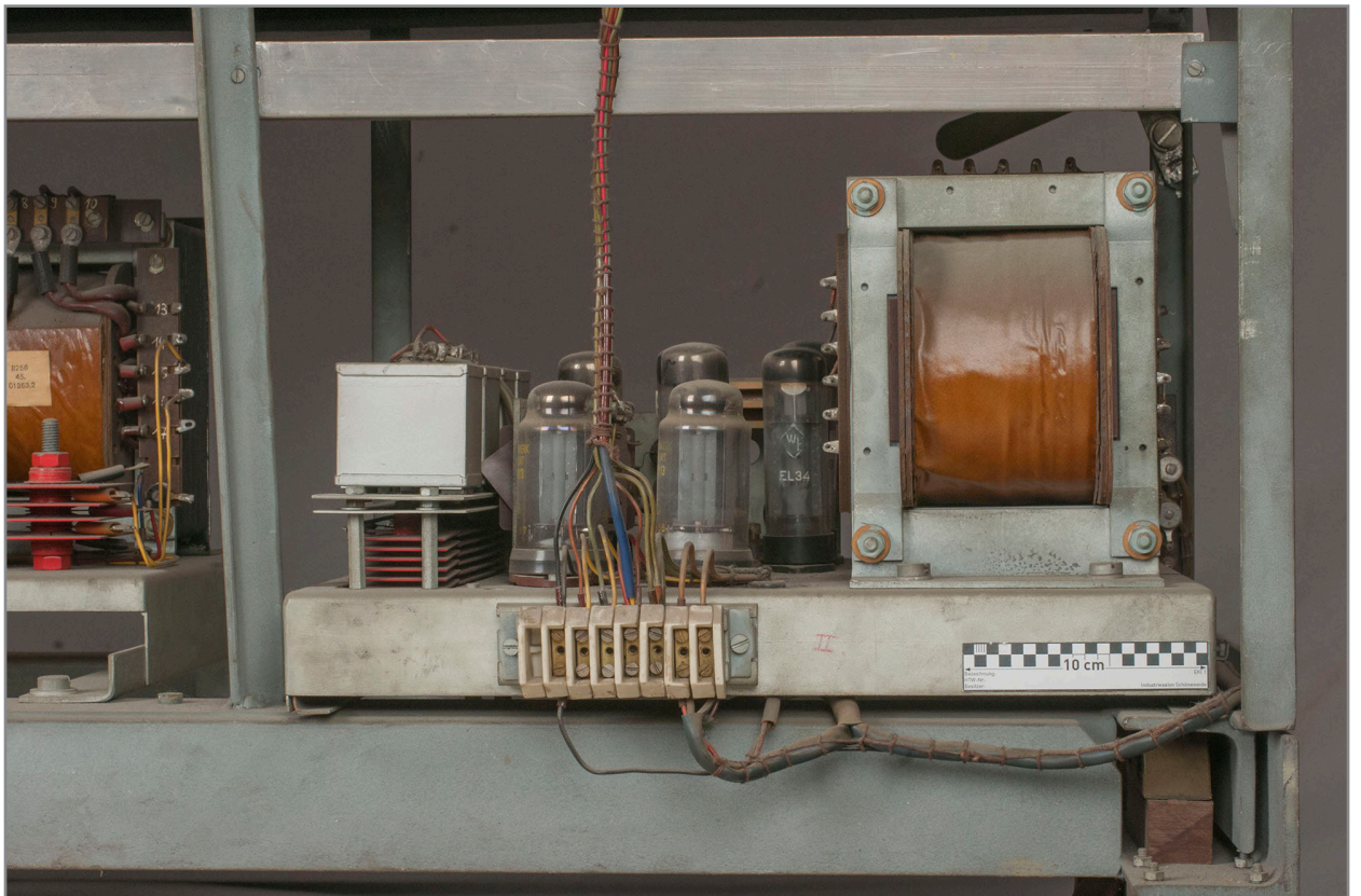
Abb. 586: Detail Spielseite Elektronikgestell, Netzgerät „II“, links Metallpapierkondensatoren, dann erkennbar die Elektronenröhren EYY 13 und EL 34, rechts ein Transformator, davor Potzellanverteilerklemmen
