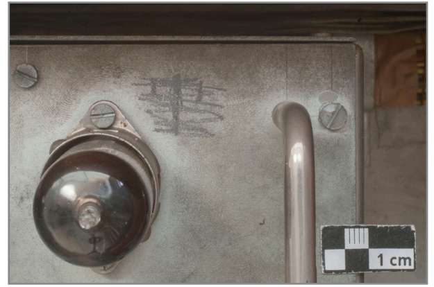
Abb. 320: Detail Vorverstärker Oberwerk, Bezeichnung mit Bleistift „T“ mehrfach durchgestrichen
