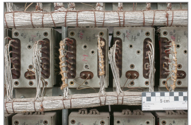
Abb. 558: Detail Spielseite Elektronikgestell, Tastsysteme Hauptwerk „e 0 f 0 “, „f #0 g 0 “ und „g #0 a 0 “, Kabel des ersten und letzten ohne Kabelbaumbindung
