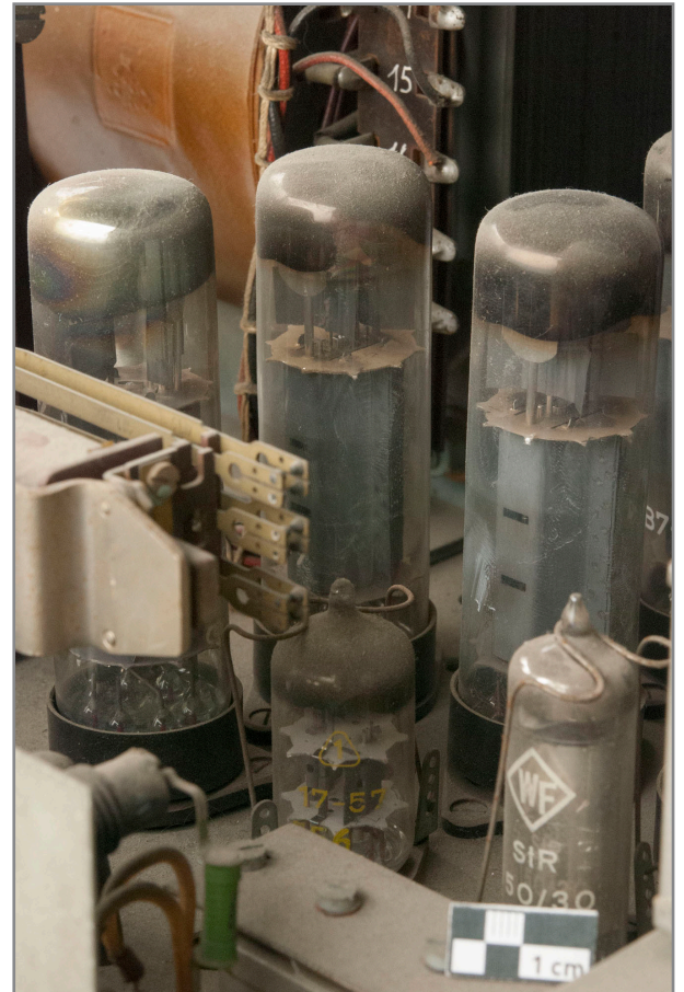
Abb. 433: Detail Rückseite Elektronikgestell, Netzgerät „II“, Elektronenröhren
