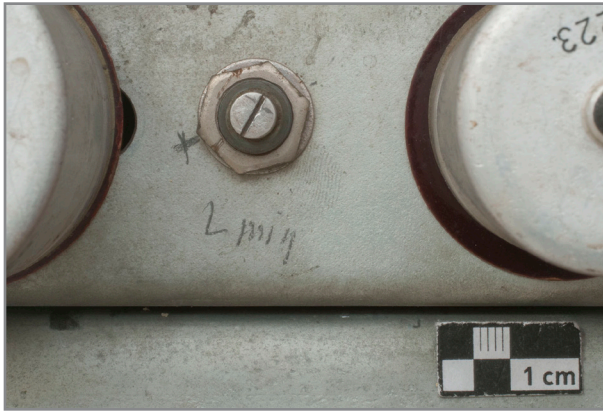
Abb. 319: Detail Vorverstärker Oberwerk, Bezeichnung eines Regelwiderstands mit Bleistift „+“ und „L min“
