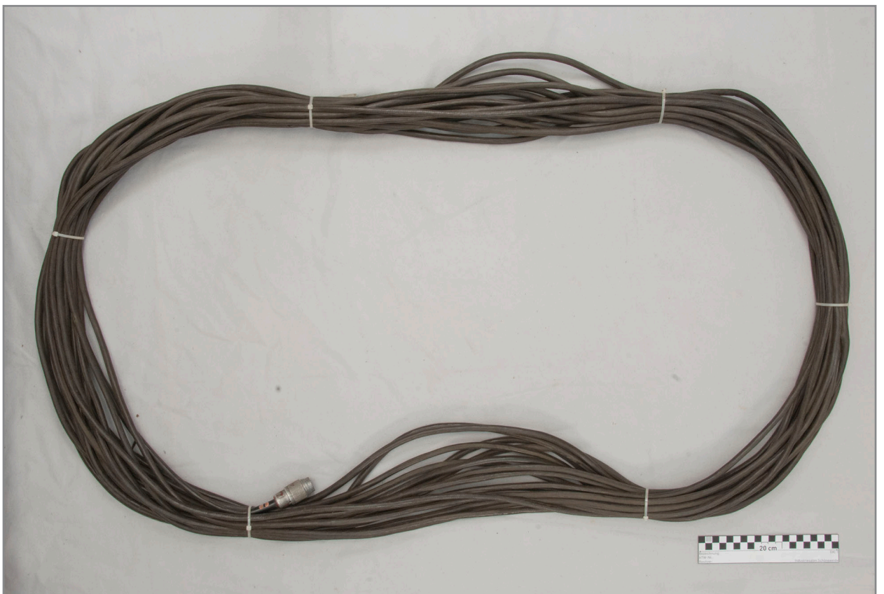
Abb. 605: Gesamtansicht Tonkabinettkabel lang (Orgel zu tonkabinett)
