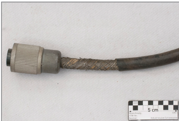
Abb. 620: Detail Tonkabinettkabel kurz II, „Neumann Stecker“ Kupplung, fehlende Isolierung
