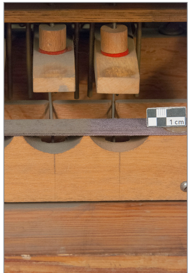
Abb. 120: Detail Fußraum, Auflagerungen auf der Pedalmechanik, rechts Reinigung mit Pinsel & Staubsauger
