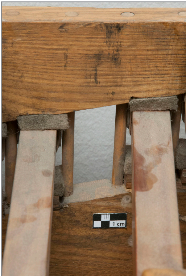
Abb. 128: Detail Pedal Orgelseite, Führung der Ganzton-Pedaltasten zwischen Holzstäben, gedämpft durch Textil
