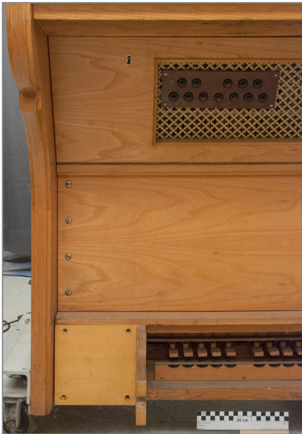
Abb. 79 & 80: Übersicht Fußraum der Orgel mit den drei Teilbereichen (vonu) Gitterelement, Schwellerwand und Pedalmechanik, Teilansichten links und Mitte links
