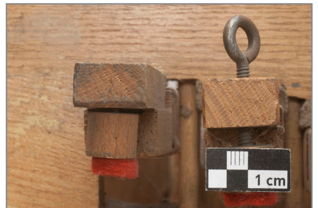
Abb. 154: Detail Orgelseite Pedal, Mechanik, Ösenverlust der Taste links im Bild
