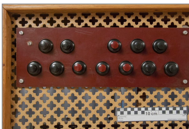
Abb. 97: Detail des Gitterelements, Kunststoffplatte mit 12 Druckknöpfen aus dem gleichen Material in verschiedenen Farben
