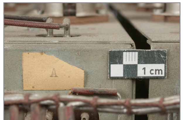
Abb. 534: Detail Spielseite Elektronikgestell, Bezeichnungsklebchen Frequenzteilerkette „A“
