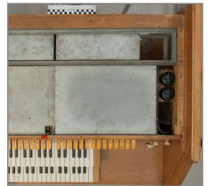
Abb. 216-218: Deckel geöffnet, Sicht auf die Filterabdeckungen unten sowie die Vorverstärker oben im Bild
