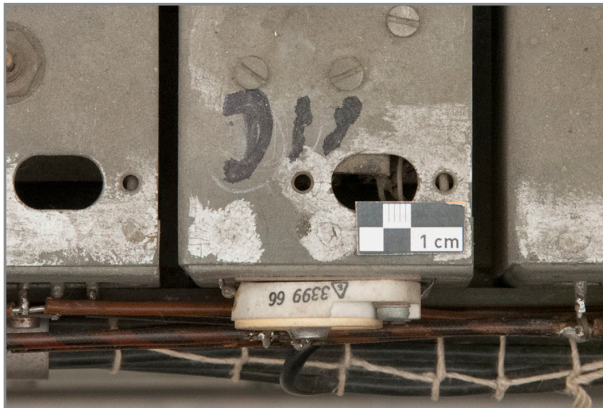
Abb. 344: Detail Oberseite Elektronikgestell, Frequenzteilerketten, Bezeichnung des Chassis mit schwarz „Dis“
