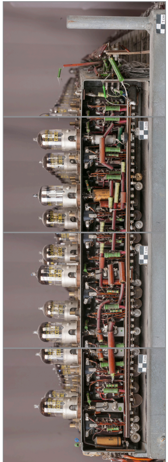
Abb. 449-452: Detailsansicht linke Seite des Elektronikgestells, zweites Chassis der Frequenzteilerkette „C“ mit Einblick in Verkabelung und elektronische Bauelemente
