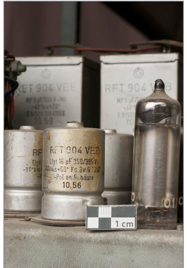
Abb. 481: Detailansicht linke Seite des Elektronikgestells, Netzgeräteebene, Metallpapierkondensatoren hinten (Netzgerät „I“), vorne Elektrolytkondensatoren sowie eine Steuerröhre des Typs St 108/30 des Netzgeräteteil „IV“
