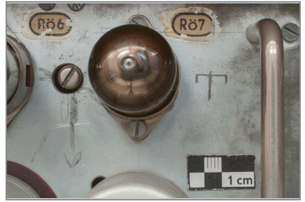
Abb. 314: Detail Vorverstärker Hauptwerk, Bezeichnung eines Regelwiderstands mit mehreren Bleistift „-“ sowie einem „T“ (mögl. für Tremulant)
