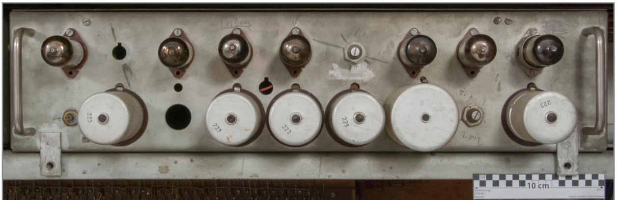
Abb. 315: Gesamtansicht Vorverstärker rechts, mit Tremulant für dsa Oberwerkv Röhren ECC 82, 81, 5x82, sechs Elektrolytkondensatoren
