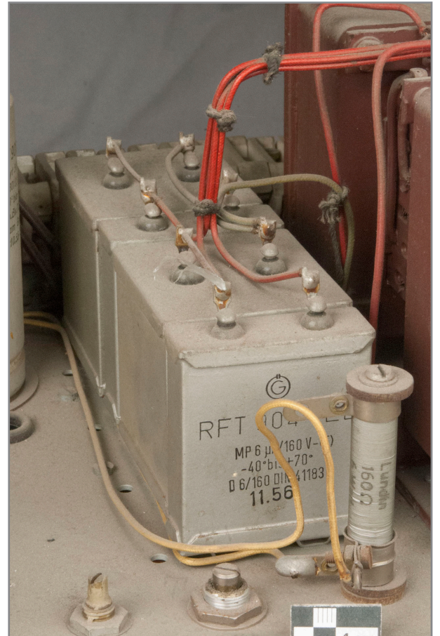
Abb. 438: Detail Rückseite Elektronikgestell, Netzgerät „III“, Metallpapierkondensatoren
