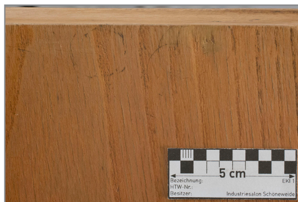
Abb. 180: Detail der Oberkante des linken Seitenteils, dunkel verfärbte, runde Abdrücke
