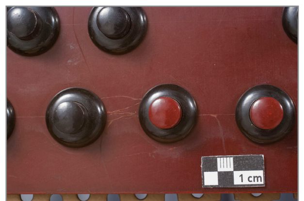
Abb. 98: Detail Kunststoffplatte des Gitterelements, Kratzer in der Oberfläche zwischen einigen Druckknöpfen
