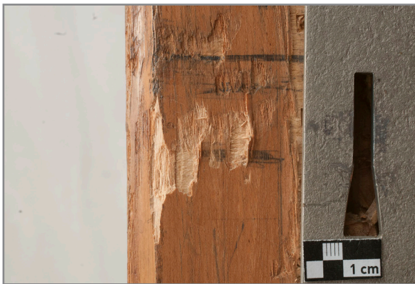
Abb. 273: Detail Innenraum rechtes Seitenteil, Ausbrüche und Markierungen des Holzes an der rückwärtigen Kante vor der Verriegelung des Elektronikgestells
