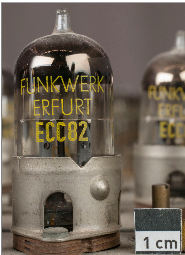
Abb. 448: Ansicht einer Elektronenröhre der Tongeneratoren Typ ECC 82 in der Fassung
