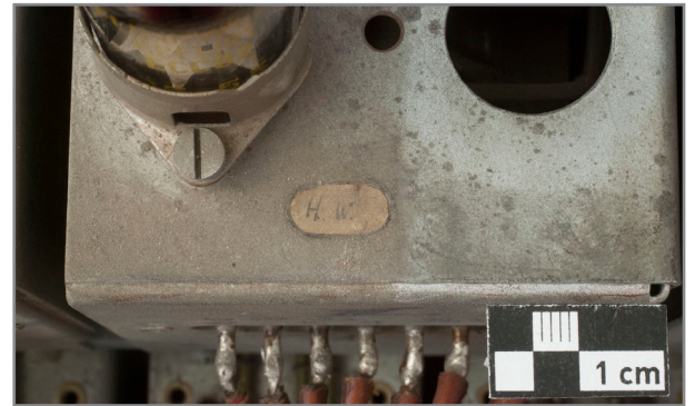
Abb. 361: Detail Oberseite Elektronikgestell, Sammelschienenverstärker Hauptwerk, rückwärtige Kante, blätterndes Bezeichnungsklebchen und Auflagerungen links vor der Trockenreinigung, rechts danach
