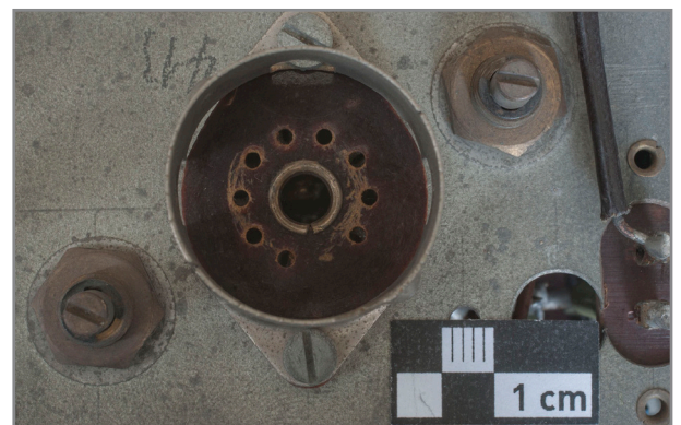
Abb. 357: Detail Oberseite Elektronikgestell, Frequenzteilerkette „C“ zweites Chassis, nach der Trockenreinigung, Abnutzungsspuren in der Röhrenhalterung
