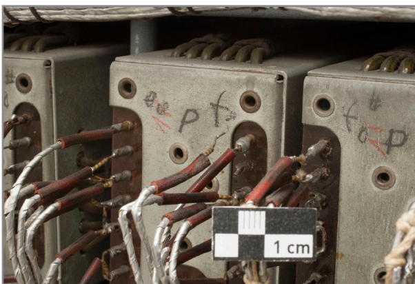
Abb. 579: Detail Spielseite Elektronikgestell, gelöstes Kabel des Tastsystems Pedalwerk „e 0 f 0 “
