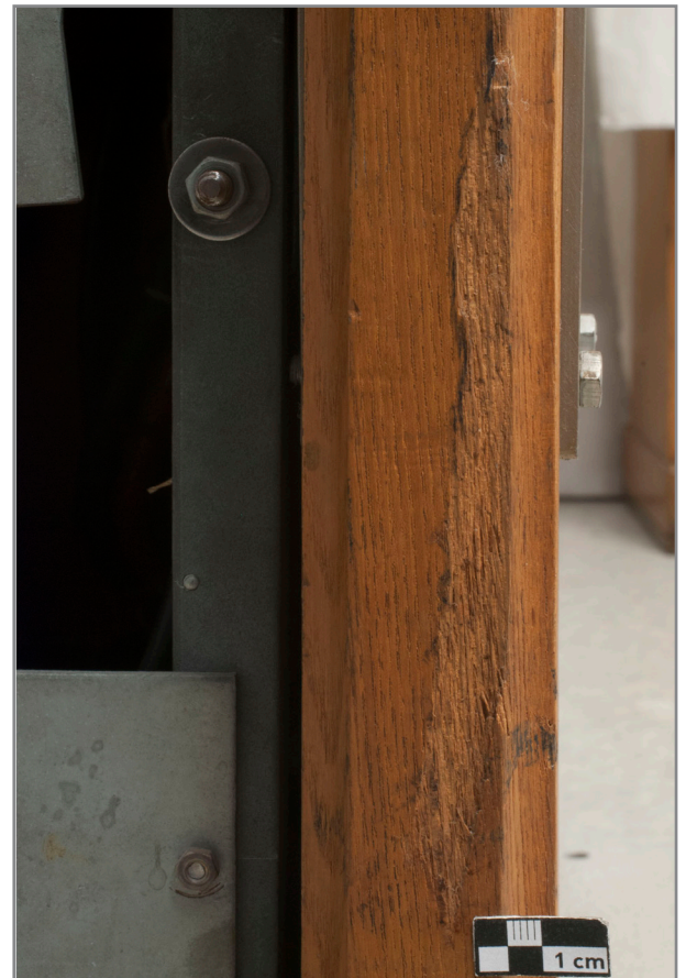
Abb. 248: Detail Rückseite, Abtrag der Holzoberfläche auf mittlerer Höhe des linken Seitenteils
