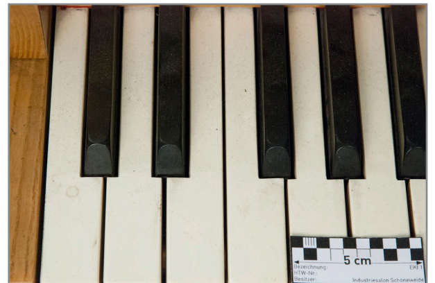
Abb. 52: Tasten C-H des Hauptwerks: Beispielhaft für Staub- und festere Auflagerungen
