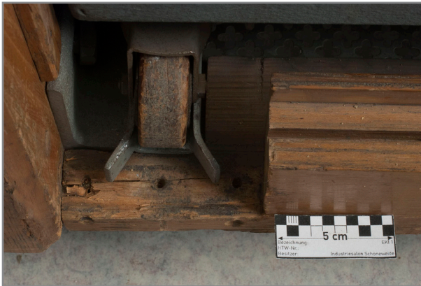
Abb. 251: Detail Rückseite, links unten, Gebrauchsspuren im Holz der Ausfahrt für die Rollfüße des Elektronikgestells
