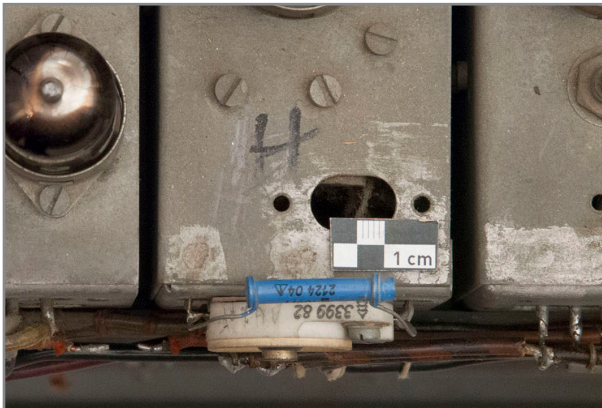
Abb. 336: Detail Oberseite Elektronikgestell, Frequenzteilerketten, Bezeichnung des Chassis mit schwarz „H“
