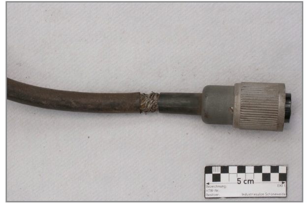
Abb. 612: Detail Tonkabinettkabel kurz I, „Neumann Stecker“ Kupplung, fehlende Isolierung
