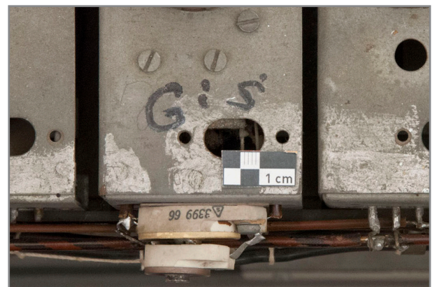
Abb. 239: Detail Oberseite Elektronikgestell, Frequenzteilerketten, Bezeichnung des Chassis mit schwarz „Gis“
