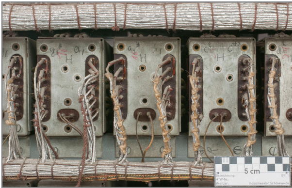
Abb. 561: Detail Spielseite Elektronikgestell, Tastsysteme Hauptwerk „g #1 a 1 “, „a #1 h 1 “ und „c 2 c #2 “, leicht eingedrückte Kabelbäume erkennbar
