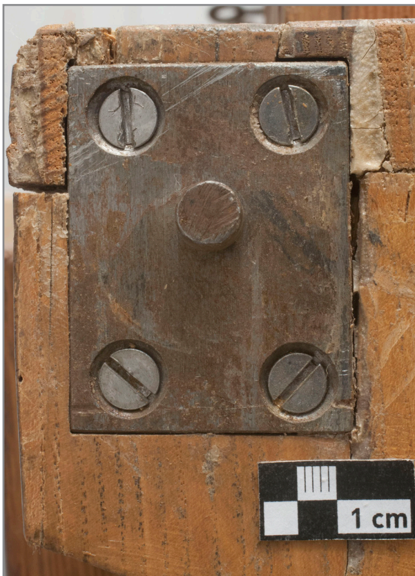
Abb. 134: Detail Pedal rechts, Orgelseite, vorderer Metalldorn zum Einhängen des Pedals im Fußraum der Orgel, Korrosion, Kratzer, Klebstoffaustritt & Risse im umliegenden Holz (hochkant)
