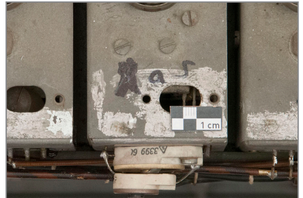
Abb. 337: Detail Oberseite Elektronikgestell, Frequenzteilerketten, Bezeichnung des Chassis mit schwarz „Aas“
