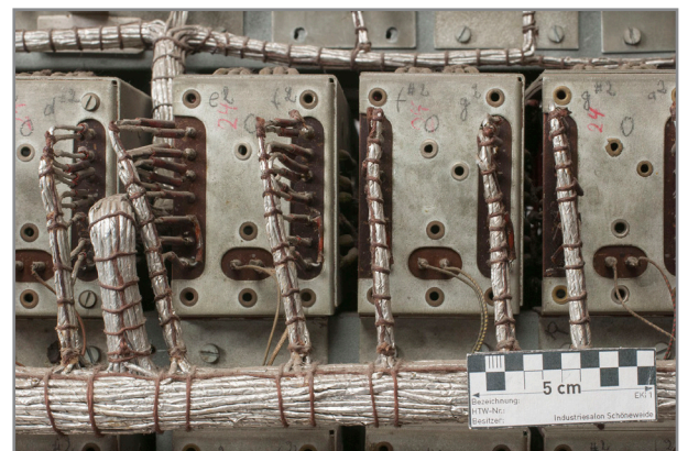
Abb. 548: Detail Spielseite Elektronikgestell, Tastsysteme Oberwerk „e2 f2“, „f#2 g2“ und „g#2 a2“
