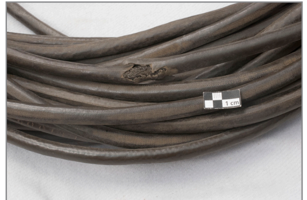
Abb. 609: Detail Tonkabinettkabel lang, Fehlstelle in der Isolierung
