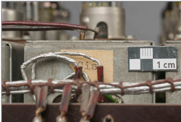
Abb. 529: Detail Spielseite Elektronikgestell, Bezeichnungsklebchen Frequenzteilerkette „Cis“
