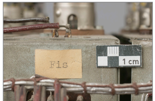
Abb. 532: Detail Spielseite Elektronikgestell, Bezeichnungsklebchen Frequenzteilerkette „Fis“
