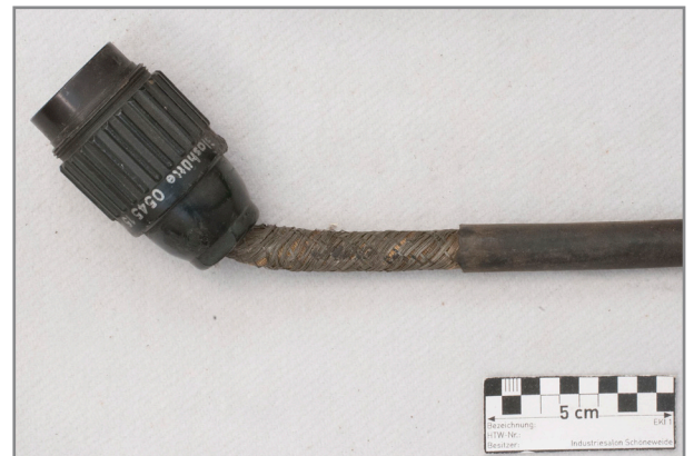
Abb. 621: Detail Tonkabinettkabel kurz II, „Neumann Stecker“ Stecker, fehlende Isolierung
