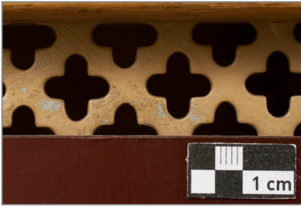
Abb.99: Detail Gitterelement, Fehlstellen im farbigen Überzug des Metallgitters über der Kunststoffplatte
