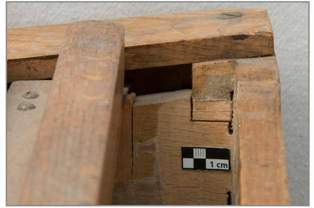
Abb. 127: Detail Pedal Oberseite, Bankseite links, fehlende Eckverbindung, Klebstoffreste, Staubauflagerungen, Ausbrüche im Holz
