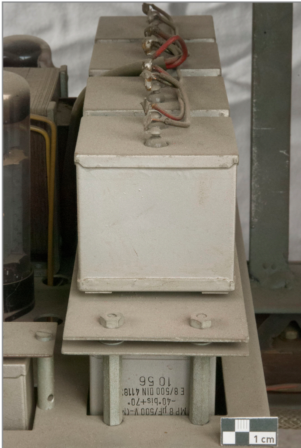
Abb. 434: Detail Rückseite Elektronikgestell, Netzgerät „II“, Metallpapierkondensatoren
