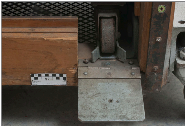
Abb. 253: Detail Rückseite, rechts unten, ausgeklappte Metallrampe zum Ausfahren des Elektronikgestells
