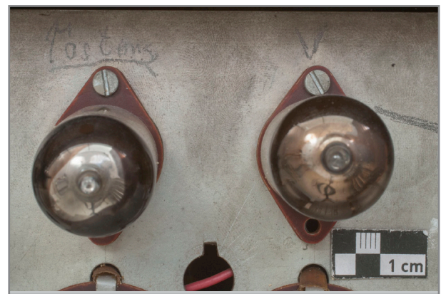
Abb. 317: Detail Vorverstärker Oberwerk, Bezeichnung einer Röhre mit Bleistift „Tastung“ sowie einer weiteren mit „V“
