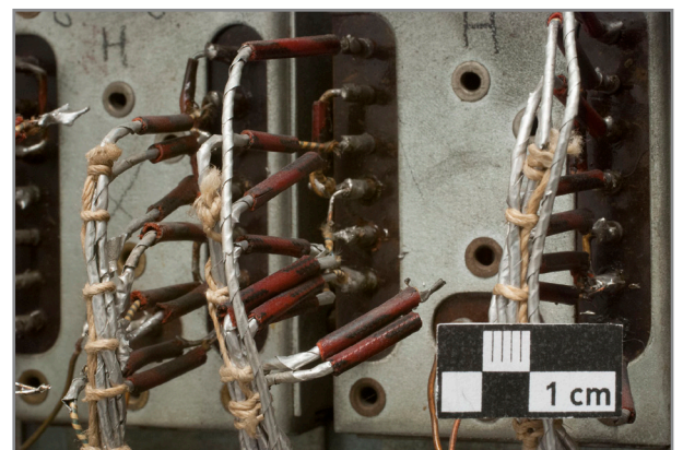
Abb. 566: Detail Spielseite Elektronikgestell, abgelöste Kabel des Tastsystems Hauptwerk „d 3 d #3 “
