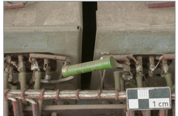
Abb. 538: Detail Spielseite Elektronikgestell, zusätzl. Widerstand zwischen Frequenzteilerketten „Gis“ und „A“
