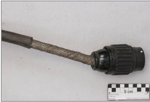
Abb. 611: Detail Tonkabinettkabel kurz I, „Neumann Stecker“ Stecker, fehlende Isolierung
