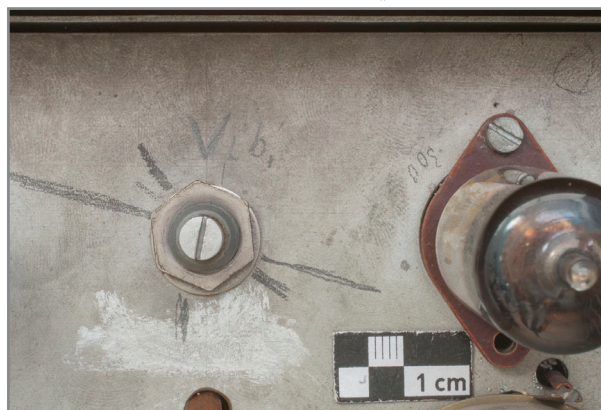
Abb. 318: Detail Vorverstärker Oberwerk, Bezeichnung eines Regelwiderstands mit mehreren Bleistift „-“ sowie „V L b“, daneben unkenntliche Bezeichnung einer Röhre
