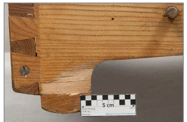
Abb. 136: Detail Pedal links, Orgelseite, Absplinterung des Holzes am Fuß, rechts oben der hintere Metalldorn zum Einhängen des Pedals an die Orgel (Vgl. Abb. 133)
