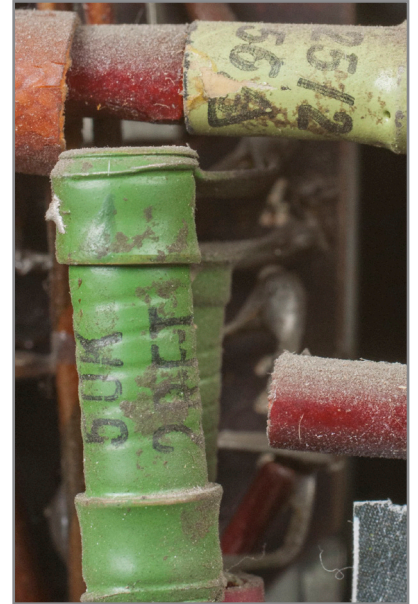
Abb. 455: Detailansicht linke Seite des Elektronikgestells, zweites Chassis der Frequenzteilerkette „C“, Widerstand
