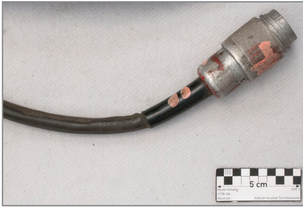
Abb. 606: Detail Tonkabinettkabel lang, „Neumann Stecker“ Stecker, rosa Farbauflagerungen
