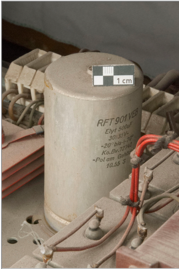
Abb. 437: Detail Rückseite Elektronikgestell, Netzgerät „III“, Elektrolytkondensator mit Beschriftung
