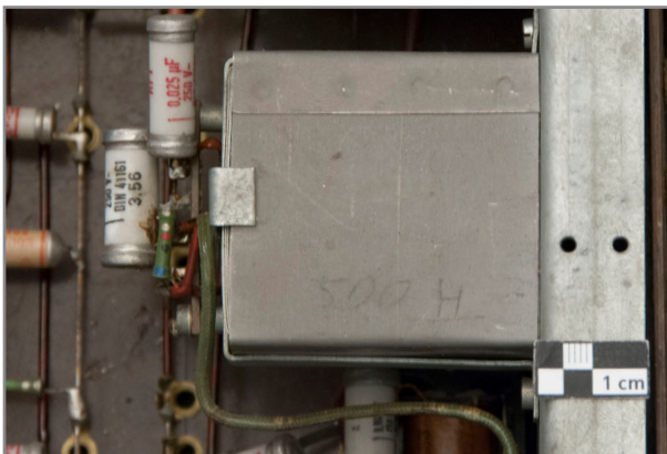
Abb. 232: Detail Filter 2, Induktivität, Bleistiftbezeichnung „500 H“
