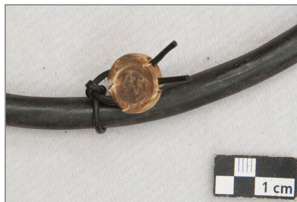
Abb. 601: Detail Netzkabel, Plombe „5“
