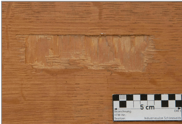
Abb. 214: Detail Deckel Innenseite, Fehlstelle im Holz, erkennbare Schichtleimung
