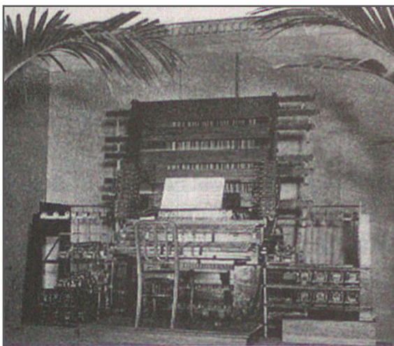
Abb. 7: Der Spieltisch des "Telharmonium" von T. Cahill, 1906
