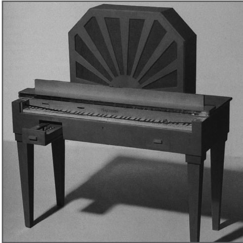
Abb. 11: Ein "Ondes-Martenot" mit Seilzug und Klaviatur, 1928 von M. Martenot
