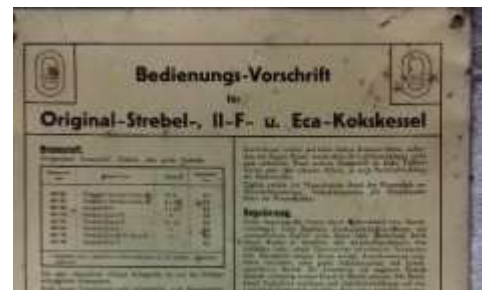
Abb. 134: Ausschnitt der Bedienungs-Vorschrift. Geheizt wurde nach Vorschrift mit „gutem Gas- oder Zechenkoks“.
