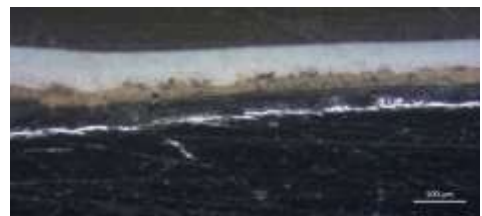
Abb. 167: Exemplarischer Beschichtungs Aufbau. Hier Zyklon Nr. 12.2.
