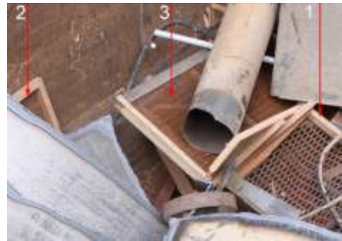
Abb. 95: Entsorgte Siebe der Aspirateure. 1: Schrollensieb (Vorsieb), 2: Schlitzblechsieb (Feinreinigung), 3: Drahtsieb (Sandsieb).
