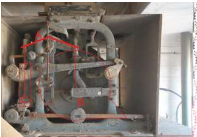
Abb. 76: Automatische Waage. Rot eingezeichnet Funktionselemente. A: Waagebalken. B: Wiegegefäß. C: Gewichtsschale.
