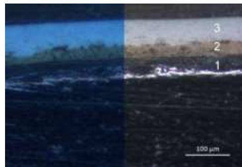
Abb. 102: Beschichtungsaufbau eines Zyklons im Speicher 3 mit hellgrauer Sichtbeschichtung.
