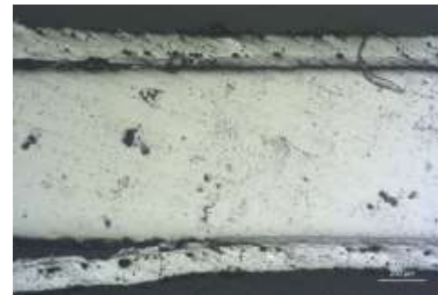
Abb. 127: Querschnitt Heizbleche, verzinkt.
