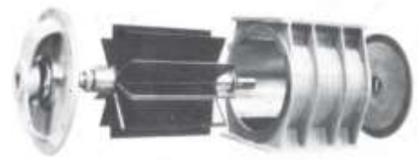
Abb. 31: Zellenradschleuse um 1980. Der Aufbau einer Zellenradschleuse hat sich im Vergleich zu den 1930er-Jahren nicht wesentlich geändert.
