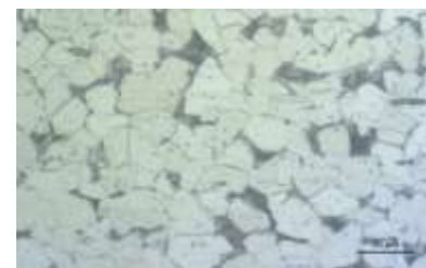
Abb. 144: Ferrit-/Perlitgefüge Gehäuse Verdampfgefäß.
