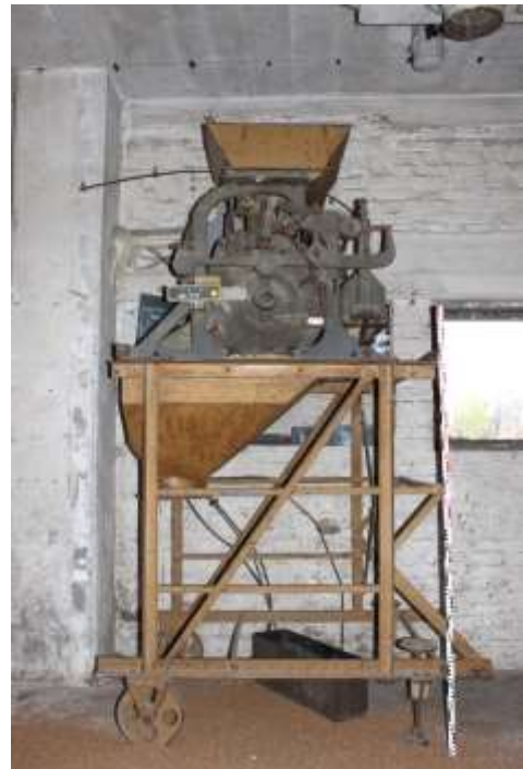
Abb. 83: Nettoabsackwaage der Chronos-Werke in Speicher 3.
