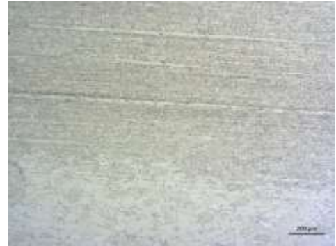
Abb. 162: Nahezu entkohltes Gefüge im unteren Randbereich. (Ventilator Nr. 10.1.)
