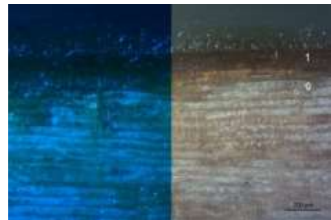
Abb. 94: In die Holzgefäße eingedrungene Harzbeschichtung. Links unter UV-Anregung keine Fluoreszenz.
