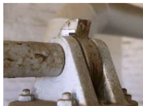
Abb. 109: Detail Abnutzung des Hubdaumens.
