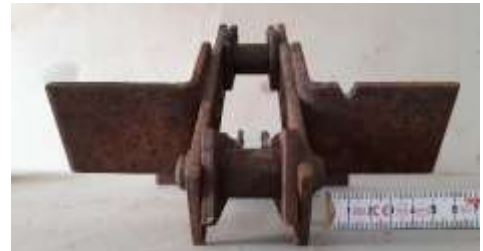
Abb. 55: Kette Typ 1 mit aufgesetzten Mitnehmern. Kettenglied zurückgeklappt.
