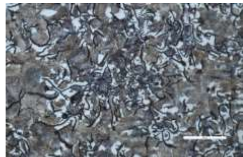
Abb. 81: Gusseisengefüge mit Lamellengraphit und Phosphid-Eutektikum.
