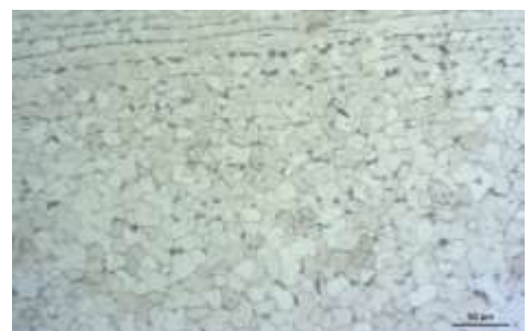
Abb. 58: Metallgefüge des Troges. Oben Längsrichtung, unten entkohlter Randbereich sichtbar.
