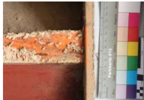
Abb. 168: Detail Trocknungsanlage. Beschichtung mit Leuchtfarbe Orange.
