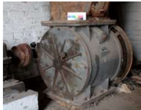
Abb. 29: Zellenradschleuse für die geregelte Abgabe von Getreide aus dem Rezipienten.
