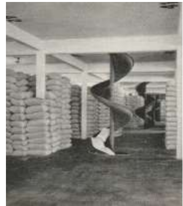
Abb. 66: Einfache Wendelrutsche. Abbildung um 1935.
