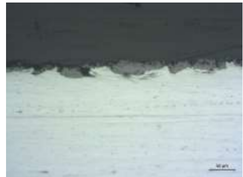
Abb. 163: Zunderschicht (dunkelgrau) auf Stahlblech (hell) ungeätzt. (Becher von Becherwerk Nr. 3.3)
