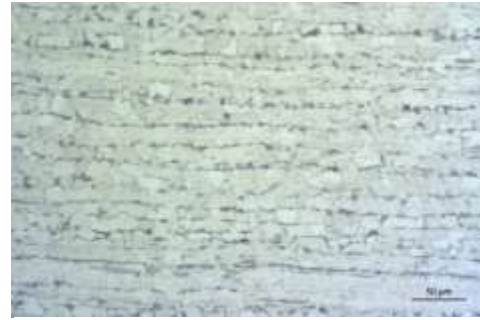
Abb. 110: Gefüge des Filtergehäuses. Längszieligkeit des gewalzten Stahls deutlich erkennbar.
