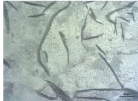
Abb. 32: Gusseisengefüge der Schleuse mit nesterförmigem Lamellengraphit und feinem Streifen zementit.
