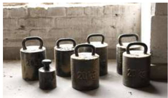
Abb. 75: Gewichte, die sich während der Nutzung in der Gewichtsschale auf der linken Seite befanden. Insgesamt 125 Kilogramm.
