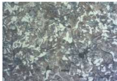
Abb. 88: Gusseisengefüge mit Perlitmatrix, Lamellengraphit und Phosphid-Eutektikum.
