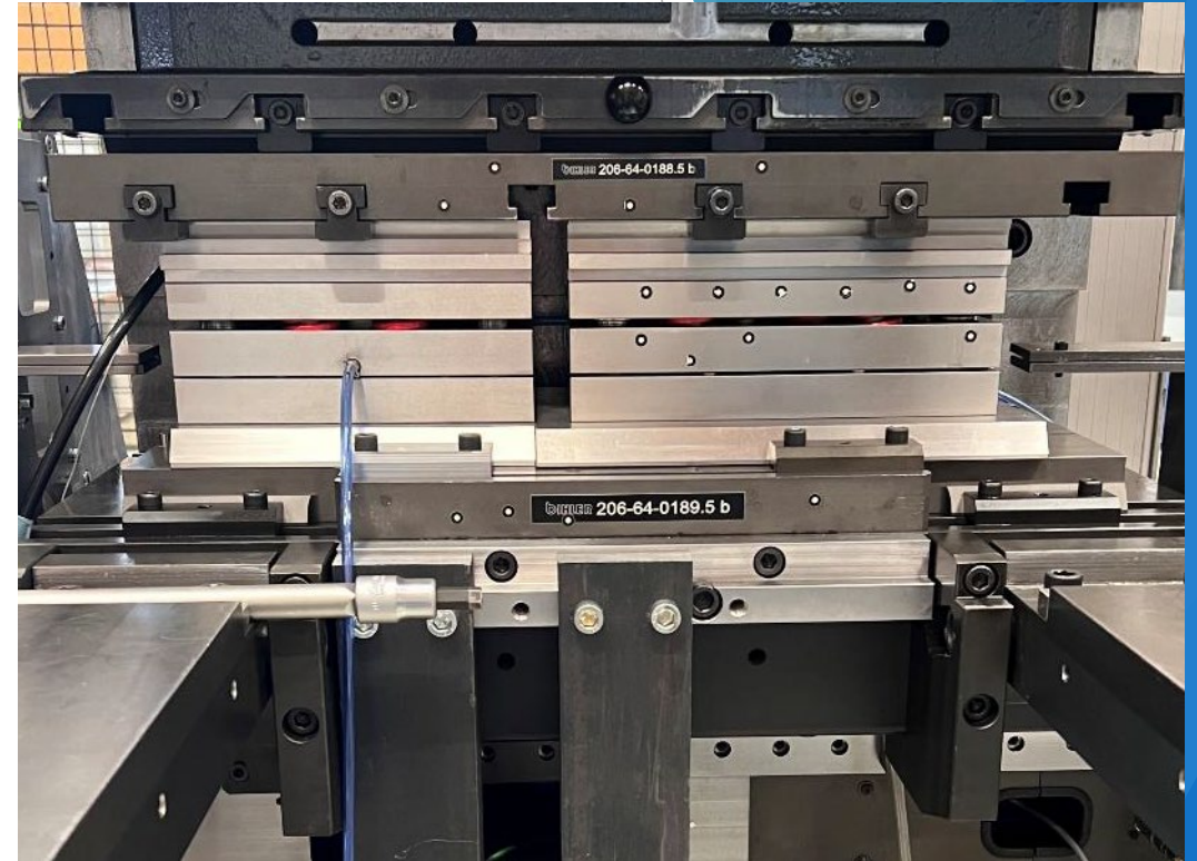
Einbausituation des pneumatischen Messmodul mit dem Standardwerkzeug der Hochschule Kempten
