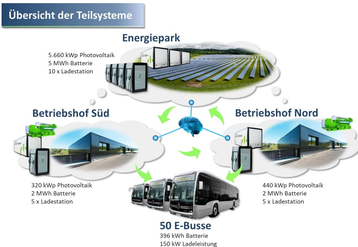
Bild 16: Übersicht über die Teilkomponenten des Energie- und Infrastrukturkonzepts
