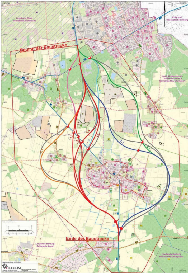
Abbildung 53: Beispiel für einen Übersichtsplan der Varianten im Rahmen der Vorplanung (NIEDERSÄCHSISCHE LANDESBEHÖRDE FÜR STRAßENBAU UND VERKEHR GESCHÄFTSBEREICH LÜNEBURG).
