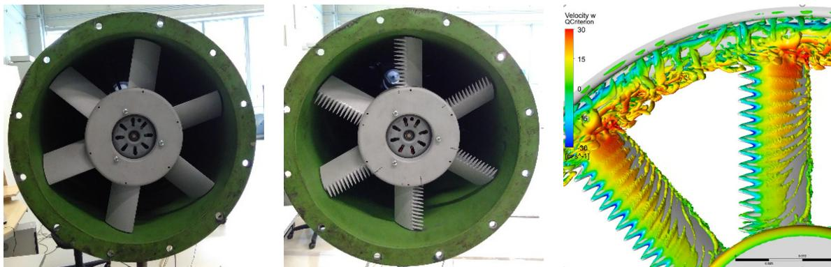
Abbildung 2: Prototypen des definierten Rotors ohne (links) und mit (mitte) *Leading Edge Serrations*, gefertigt aus Alumide. Rechts: Exemplarische Abbildung der numerischen Validierung mit Hilfe des Q-Kriteriums, koloriert über die Strömungsgeschwindigkeit. Entnommen aus (Biedermann et al. 2018c).
