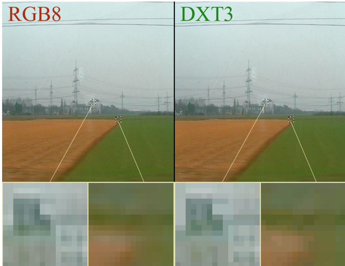
Abbildung 5.1.: Vergleich RGB (von DV-Material) und DXT3
