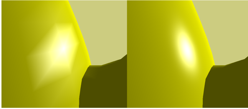
Abbildung 2.5.: Pixelberechnung nach Gouraud (li.) und Phong (re.) im Vergleich
