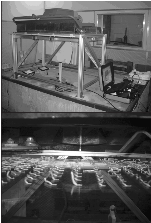
Abb.6: Versuchsaufbau zur Strömungsmessung und -visualisierung
