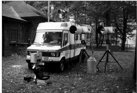
Abb.2: Abbildung 2 zeigt den Messwagen des Labors für Umweltmesstechnik zusammen mit zwei FTIR-Fernmesssystemen (rechts neben dem Messwagen), zwei UV-DOAS-Fernmesssystemen (auf dem Dach) und einem Laser-Messsystem (vor dem Messwagen)
