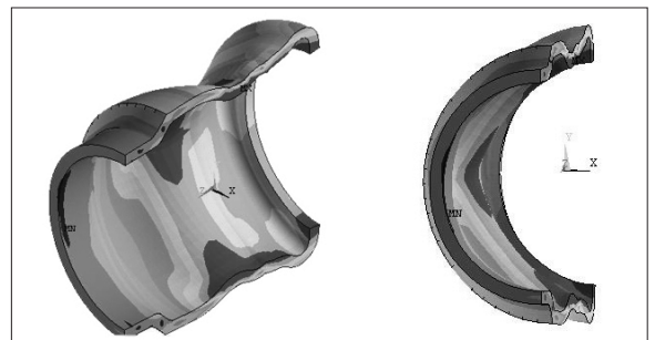
Abb.9: Finite-Element-Analyse eines plastisch verformten Fittings
