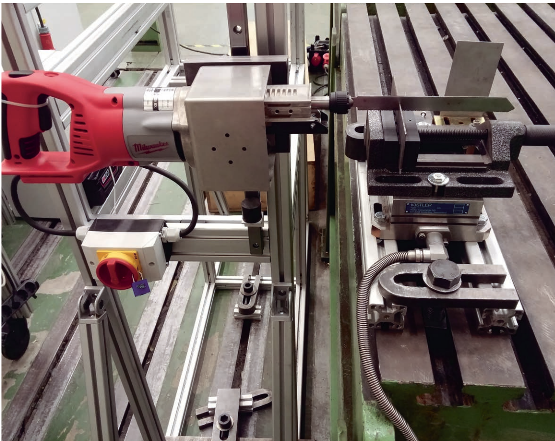
PRÜFSTAND FÜR SÄGEVERSUCHE
