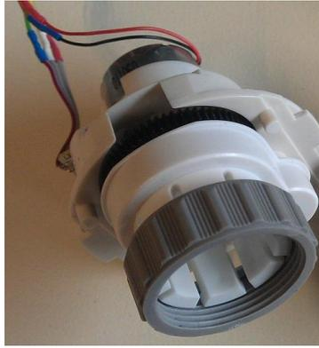
Abbildung 2: Motor und Getriebe
