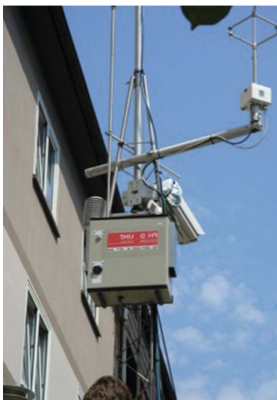
Feinstaubmessgerät der FH D in der Gladbecker Straße in Essen
