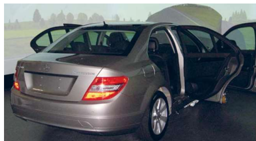
Simulation fahrdynamischen Verhaltens eines Mittelklassefahrzeugs mit Automatikschaltung (Fixed-Base-Simulator).
