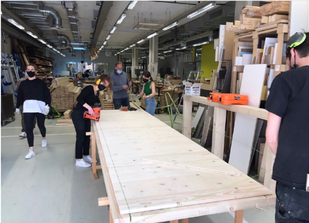
Abbildung 27: Vorfertigung der Treppe in der Holzwerkstatt der HSD, Foto Team MIMO
