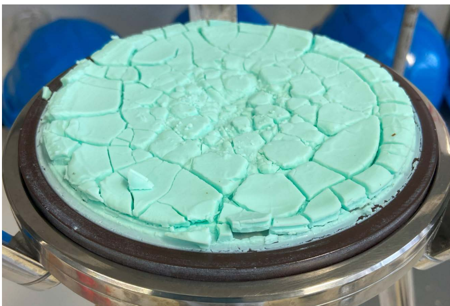
Abbildung 2: Mittels (Co-)Fällung präparierter Katalysatorvorläufer.
