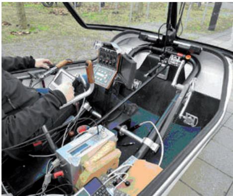
Mess-Elektrofahrrad der FHD »TWIKE« mit Instrumenten beim Start zur Messfahrt. Foto: Labor für Umweltmesstechnik, FH D
